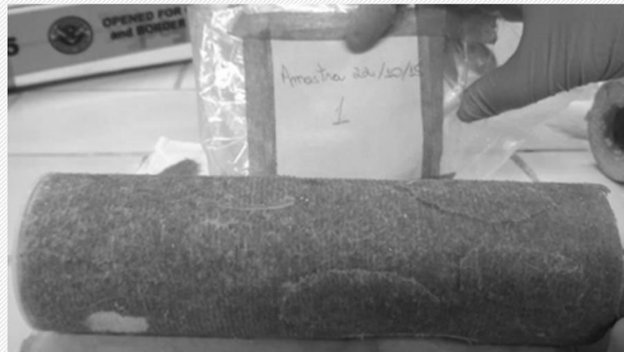
Amostra de filtro cartucho com deposição de ferro devido à corrosão de equipamentos à montante da sua instalação
