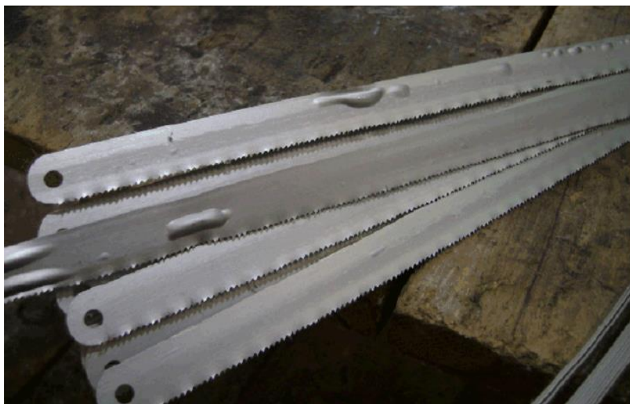
Figura 2 – Lâminas de serra que apresentaram bolhas após tratamento térmico de têmpera em forno a vácuo.
