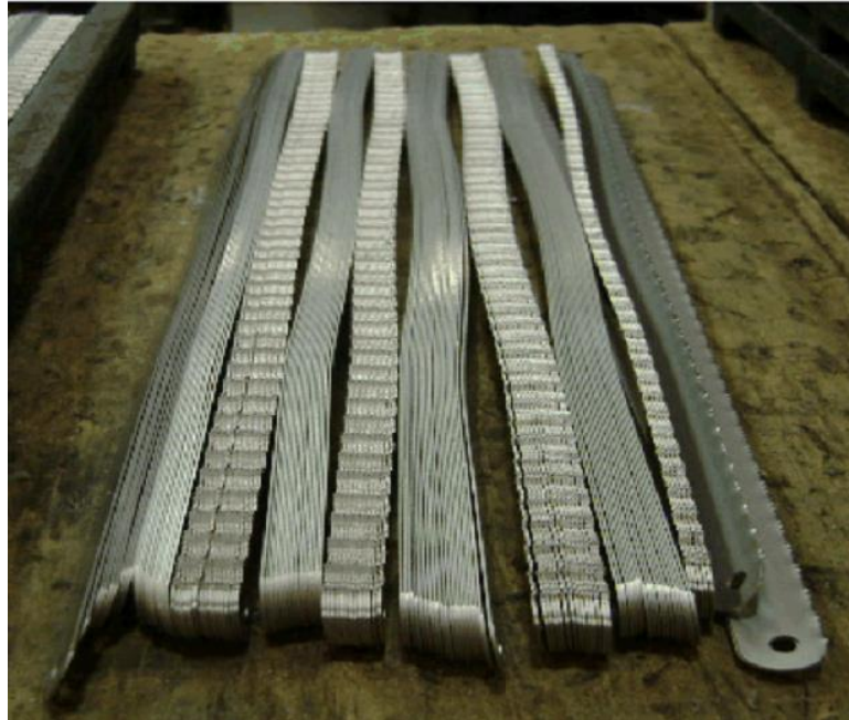
Figura 1 – Pacotes de lâminas apresentando sinuosidade após tratamento de têmpera em forno a vácuo.
