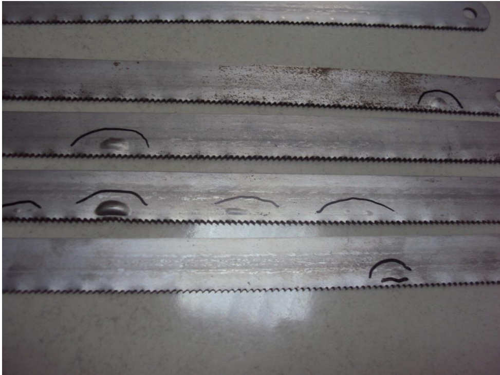
Figura 3 – Lâminas de serra que apresentaram bolhas e problemas de acabamento superficial após tratamento térmico de têmpera em forno a vácuo.
