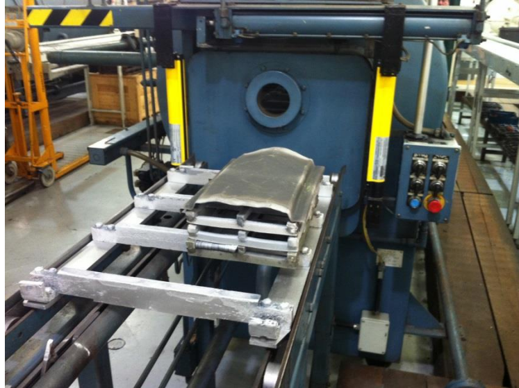
Figura 4 - Carga montada para entrada em forno a vácuo de austenitização e têmpera por sopro de nitrogênio.
