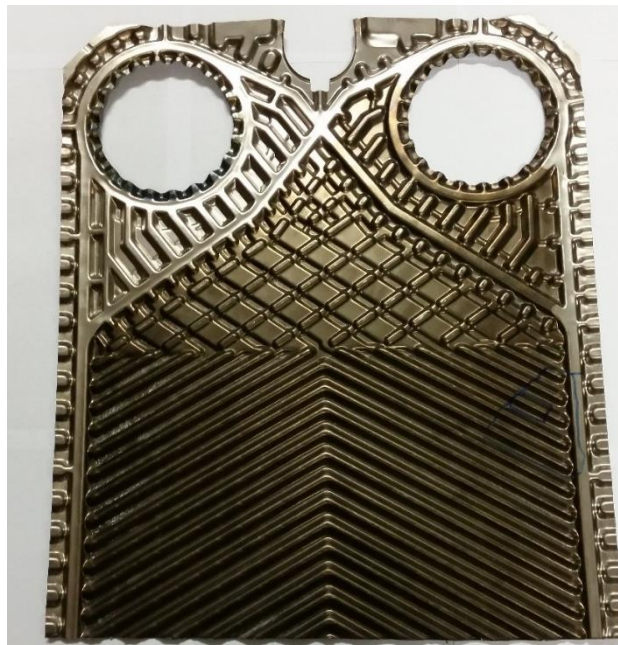
Figura 1- Superfície da placa de titânio do lado (A) que apresentou algumas manchas
