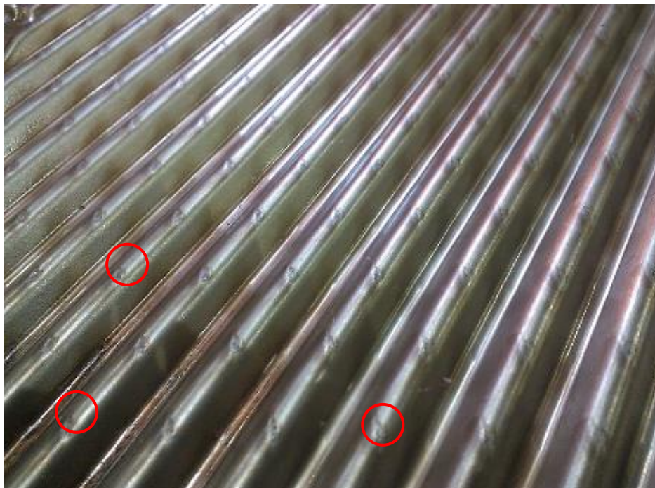
Figura 3 - Superfície da placa de titânio do lado B, que apresenta grande número de pontos de corrosão, como os assinalados por círculos vermelhos.
