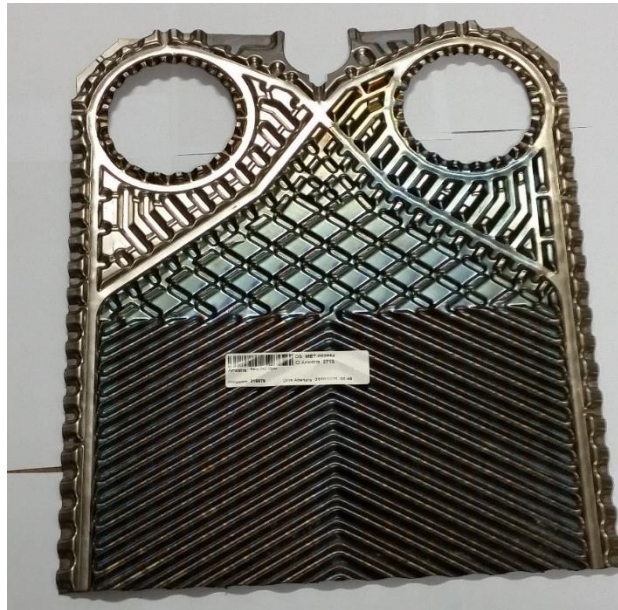
Figura 2- Superfície da placa de titânio do lado (B) que apresenta grande número de pontos de corrosão.
