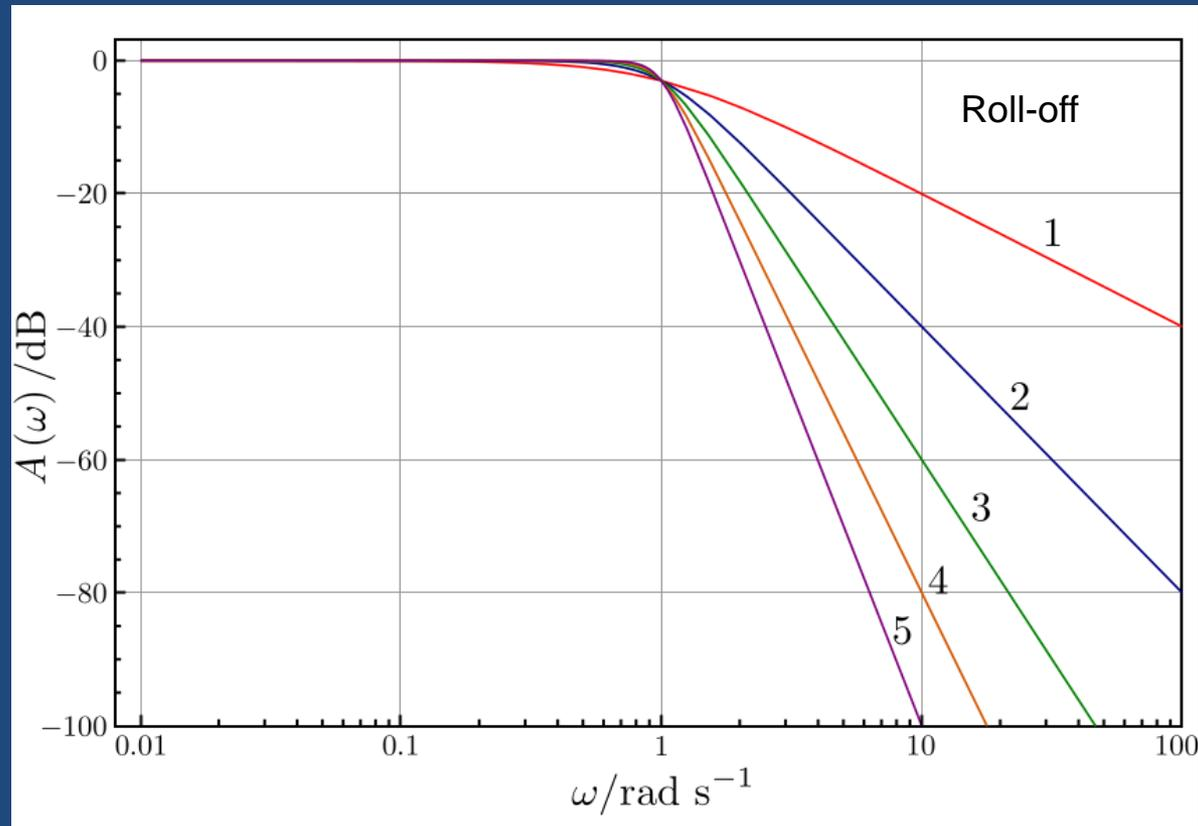
Roll-off: razão de atenuação acima da frequência de corte
