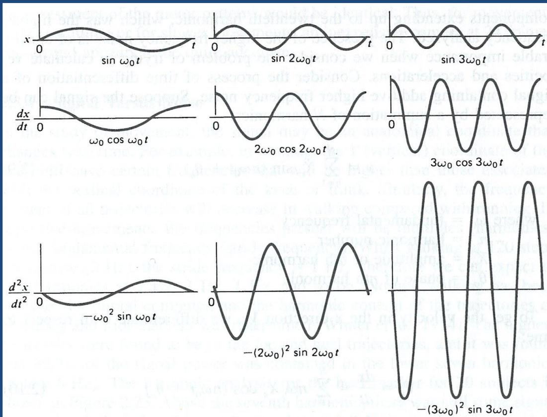
O aumento da frequência, aumenta a amplitude da velocidade e da aceleração
