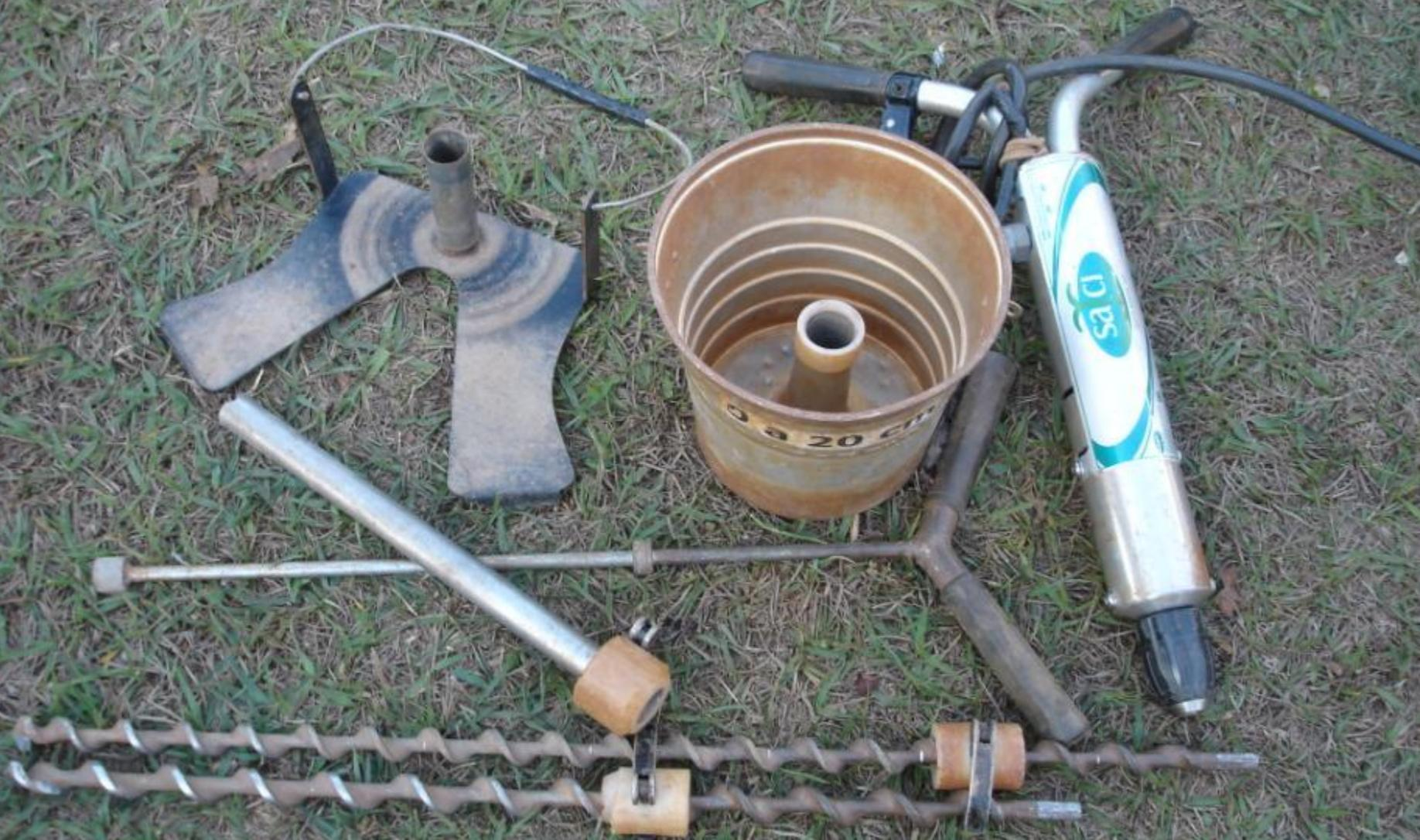
Amostrador tipo rosca, de acionamento por motor de combustão interna (furadeira), operado manualmente
