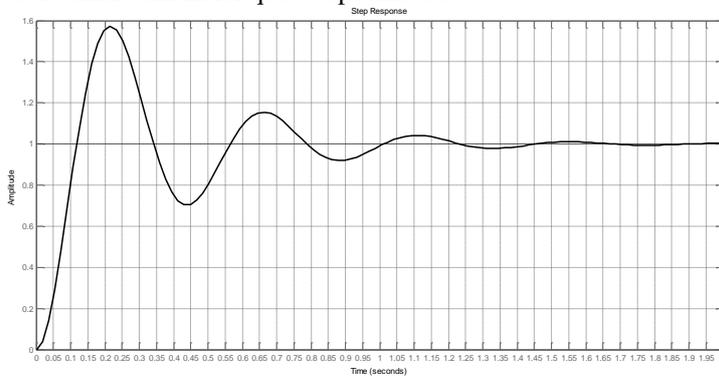
A causa disso é creditada à existência de uma dinâmica elétrica (devido à indutância do motor) desprezada na fase de modelagem e projeto do controlador, do tipo  $\frac{1}{T_E s + 1}$ . A partir do gráfico acima, estime o valor da constante de tempo elétrica  $T_E$ .
