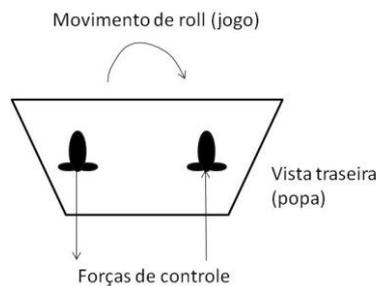
O modelo matemático obtido para um barco modelo (escala reduzida), sendo  $\theta$  o ângulo de jogo (roll) medido por um inclinômetro e  $M$  o momento (binário) gerado pelos propulsores de controle é:
