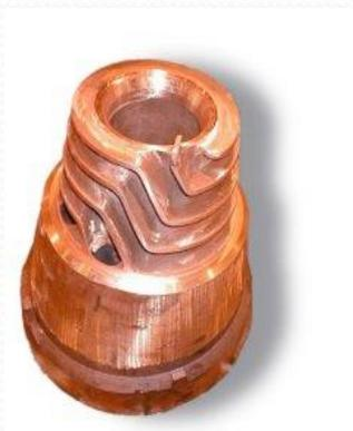
Ventaneira de cobre cortada mostrando circulação de água de refrigeração
