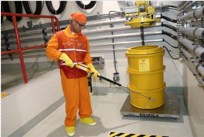
Monitoramento de tambor contendo rejeitos de baixa e média atividade
