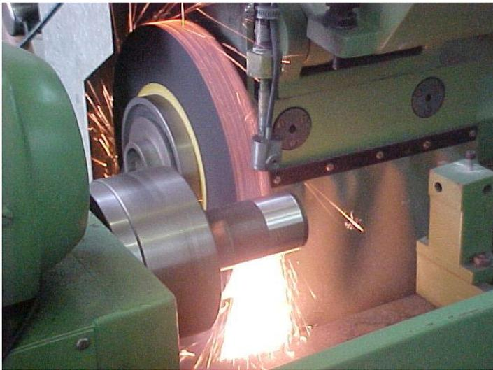
Retificação Cilíndrica Externa
