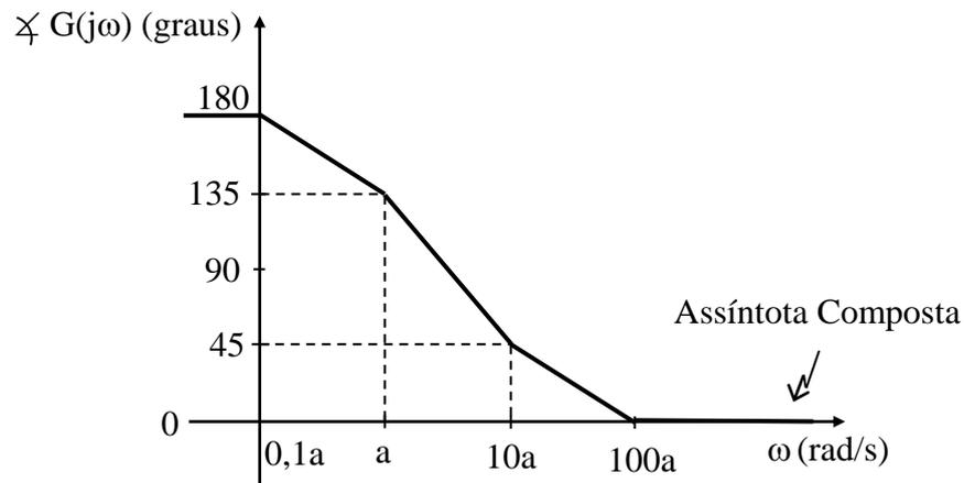
**Possível aplicação:** Circuito passa-altas para remoção de nível DC em sinal senoidal de frequência  $\omega > 10a$ .
