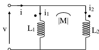
$$\begin{bmatrix} v \\ v \end{bmatrix} = \begin{bmatrix} L_1 & |M| \\ |M| & L_2 \end{bmatrix} D \begin{bmatrix} i_1 \\ i_2 \end{bmatrix} \rightarrow D \begin{bmatrix} i_1 \\ i_2 \end{bmatrix} = \frac{1}{L_1 L_2 - M^2} \begin{bmatrix} L_2 & -|M| \\ -|M| & L_1 \end{bmatrix} \begin{bmatrix} v \\ v \end{bmatrix}$$
