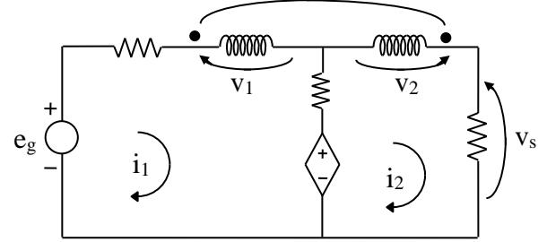
$$\text{Substituindo e simplificando, } \begin{cases} (3 + r + D)i_1 - (D + 1)i_2 = e_g \\ -(r + D + 1)i_1 + (3 + 2D)i_2 = 0 \end{cases}$$
