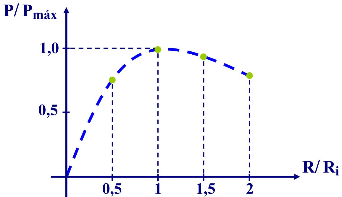
Condições:  $\left\{ \begin{array}{l} (X+X_i)^2/R_i^2 \ll 1 \\ R \approx R_i \end{array} \right.$
