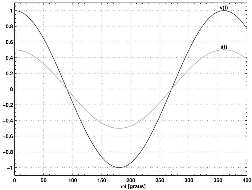
**Fig. 1.14** Relação temporal entre corrente e tensão em resistor ideal.
