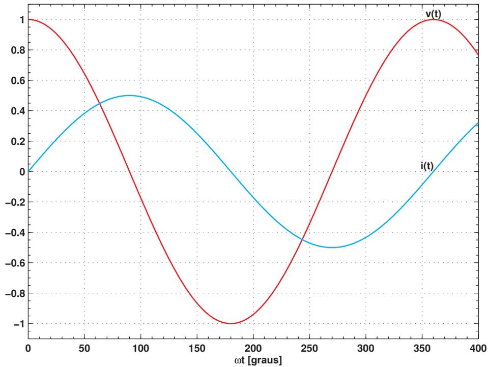
**Fig. 1.5** Relação temporal entre corrente e tensão em indutor ideal.
