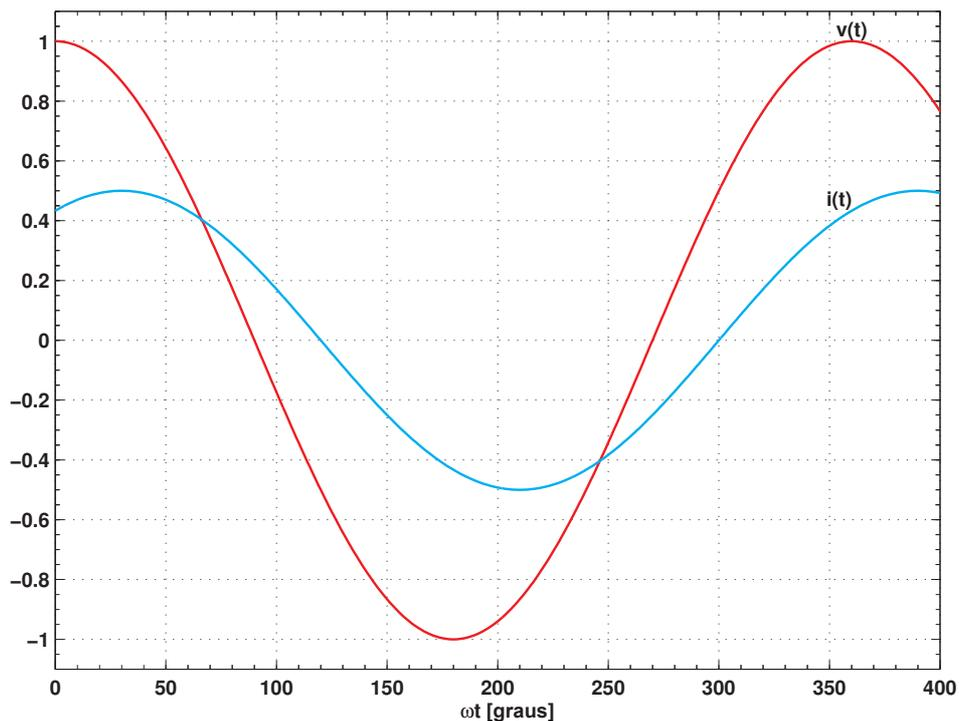
**Fig. 1.20** Relação temporal entre corrente e tensão para circuito RL.
