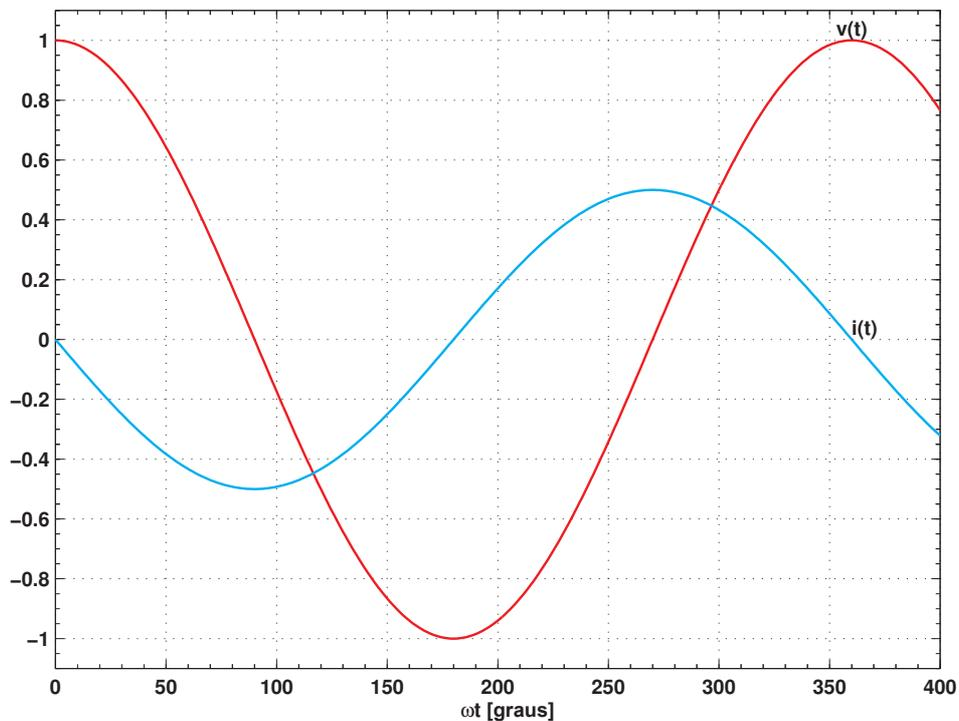
Fig. 1.7 Relação temporal entre corrente e tensão em capacitor ideal.
