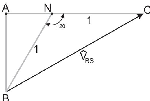
**Fig. 1.13** Figura derivada da Fig. 1.12 utilizada para deduzir o “coeficiente mágico”  $\sqrt{3}$  (Etapa 2).
