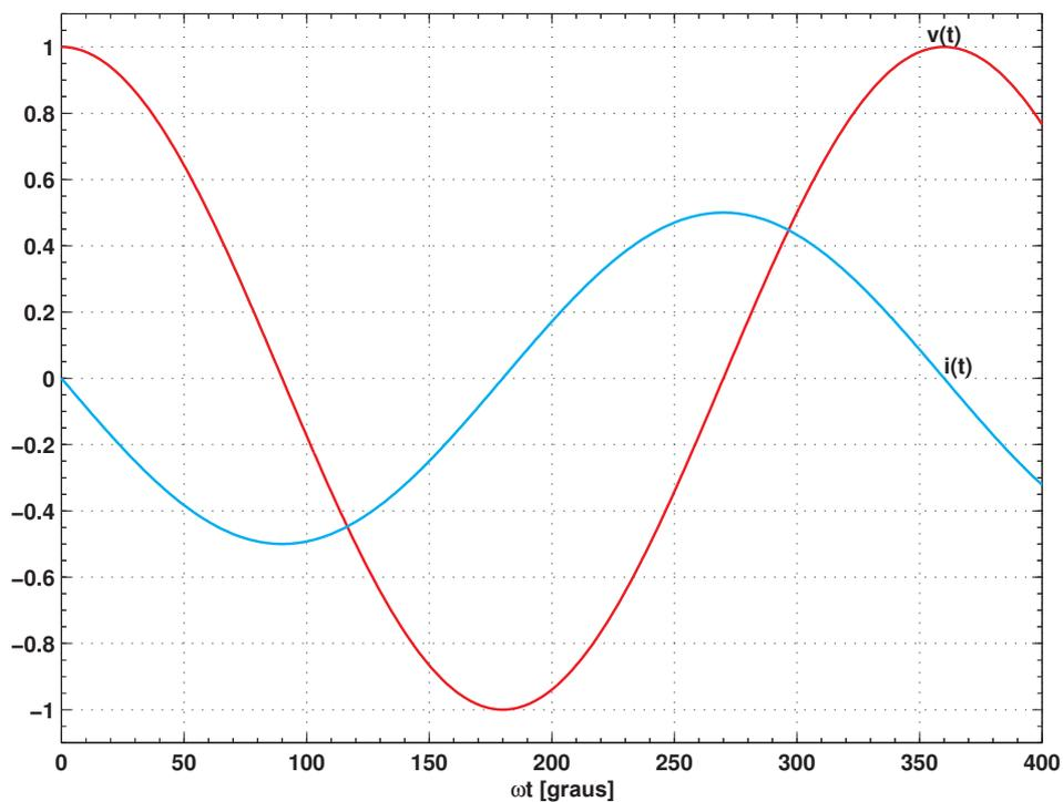
Fig. 1.18 Relação temporal entre corrente e tensão em capacitor ideal.
