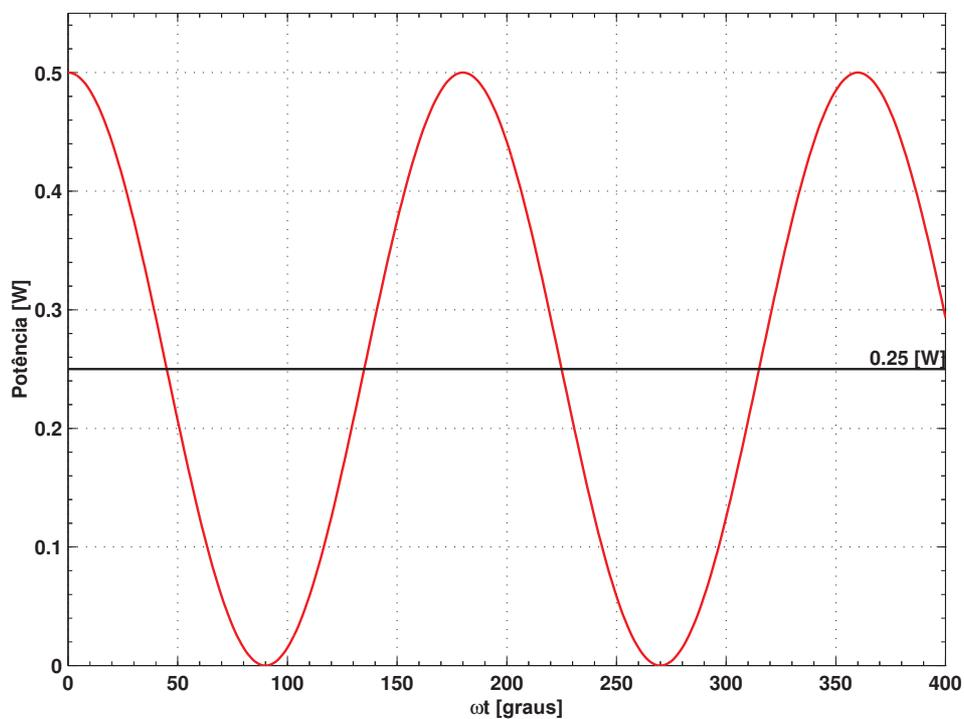
**Fig. 1.15** Potência instantânea em um resistor ideal tomando-se como base a Fig. 1.14. O valor médio da potência calculado é de 0.25 [W].
