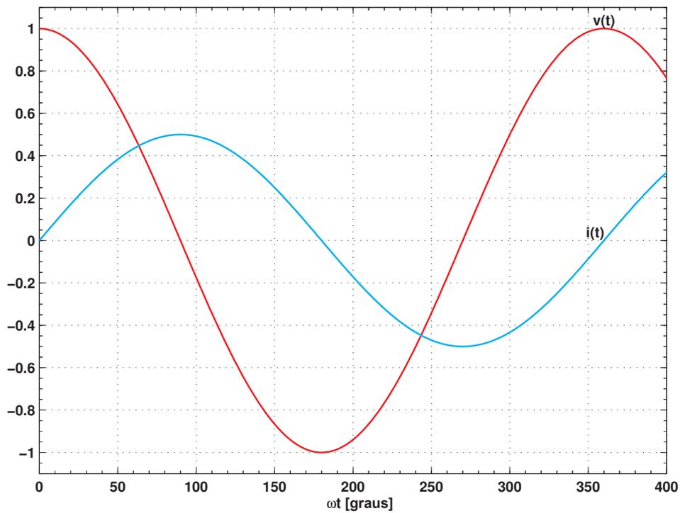
Fig. 1.16 Relação temporal entre corrente e tensão em indutor ideal.
