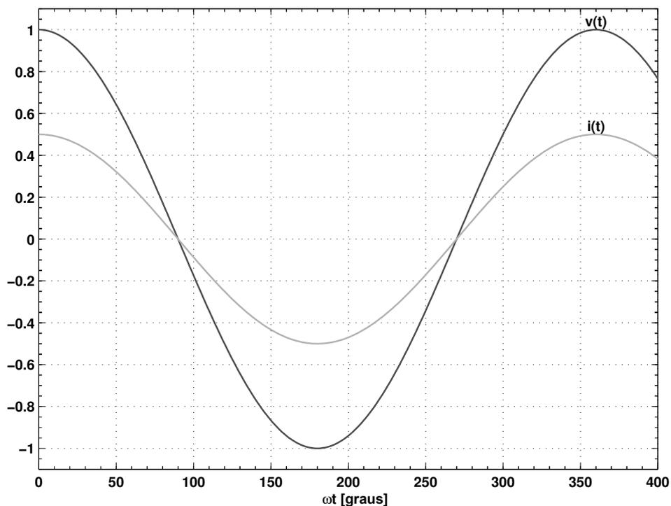
**Fig. 1.3** Relação temporal entre corrente e tensão em resistor ideal.
