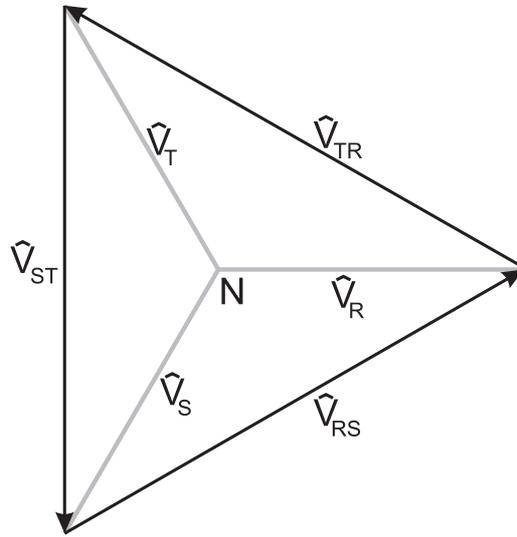
**Fig. 1.11** Sistema de tensões trifásico, com ligação delta.
