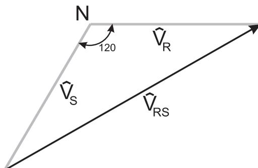
**Fig. 1.12** Figura derivada da Fig. 1.11 para deduzir o “coeficiente mágico”  $\sqrt{3}$  (Etapa 1).
