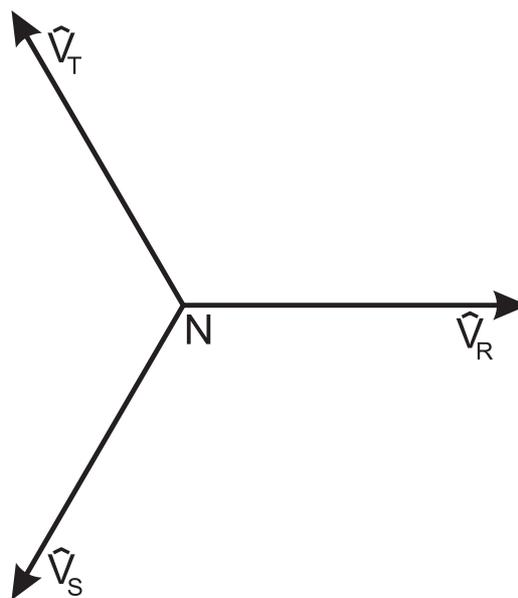
**Fig. 1.10** Sistema de tensões trifásico, com ligação estrela.
