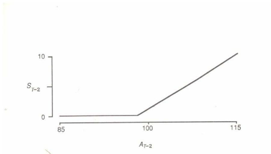
Figura 5.11. Regra ótima de armazenamento – 3 períodos
