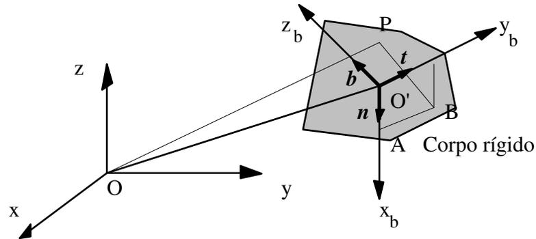
$$\vec{X}_P = \begin{bmatrix} x^P \\ y^P \\ z^P \end{bmatrix}, \mathbf{O}-x, y, z \quad \vec{X}_P^b = \begin{bmatrix} x_b^P \\ y_b^P \\ z_b^P \end{bmatrix}, \mathbf{O}-x_b, y_b, z_b,$$
