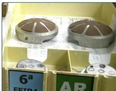
**Foto 4.2.1-5** – O bloco pronto é encaminhado à Etapa 3, juntamente com o molde, preparado com lixa adesiva (em pétalas, para ajuste a qualquer curvatura)
