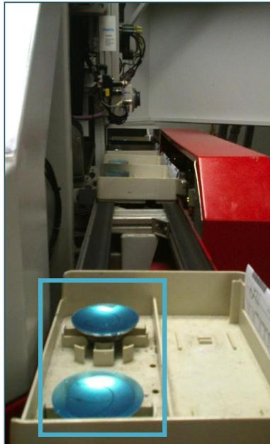
Foto 4.3-1 - Processo digital. Lentes na saída da máquina, antes do polimento, ainda com o adesivo plástico de proteção.
