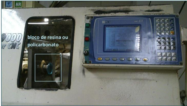
Foto 4.2.1-6 – Etapa 3: torno CNC, com bloco a ser desgastado.
