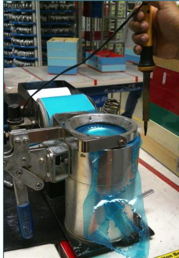
Foto 4.2.1-1 - Etapa 1. Sistema pneumático que empurra a lente para cima, prendendo-a ao adesivo.
