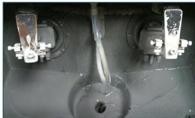
Foto 4.1.1-4 - aspecto da mistura de água e carbureto de silício.
