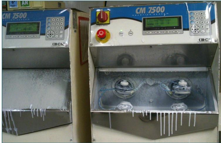
Foto 4.2.1-9 – Máquinas responsáveis pelo acabamento final, com óxido de alumínio.
