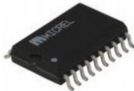
Figura 5.4 Encapsulamento SOIC
