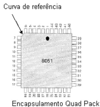
Figura 5.5 Encapsulamento QFP.
