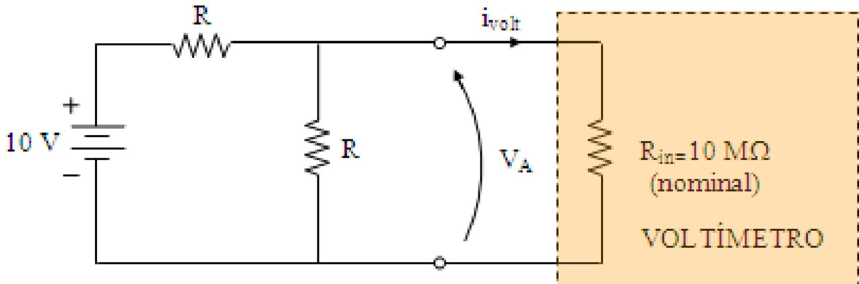
**Figura 4 – Resistência Interna do Voltímetro**
