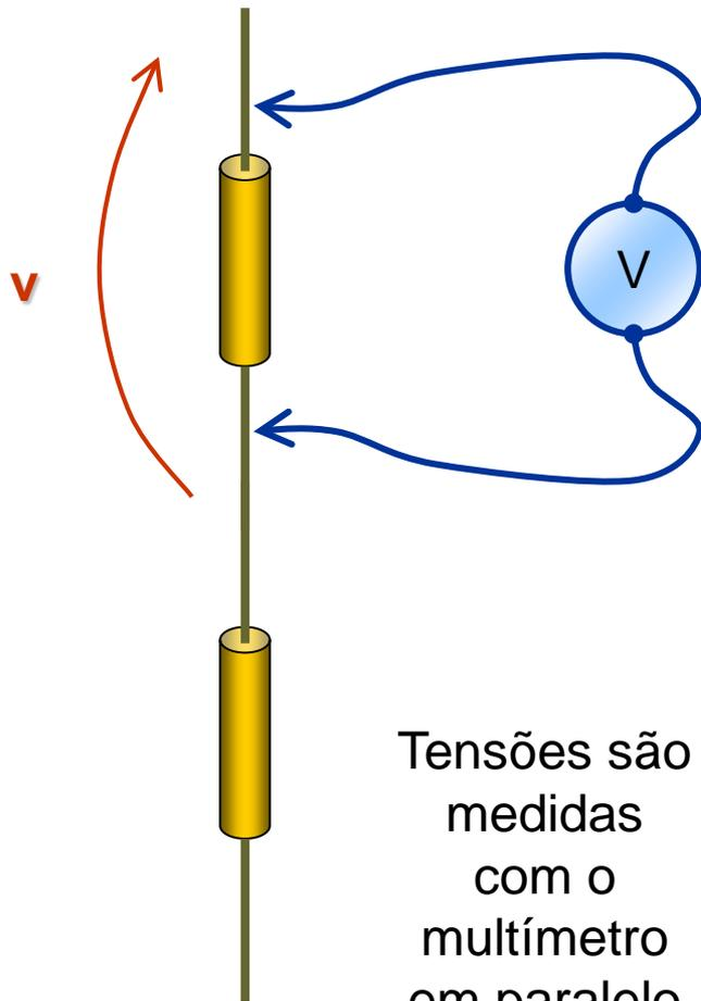
Tensões são medidas com o multímetro em paralelo com o ramo
