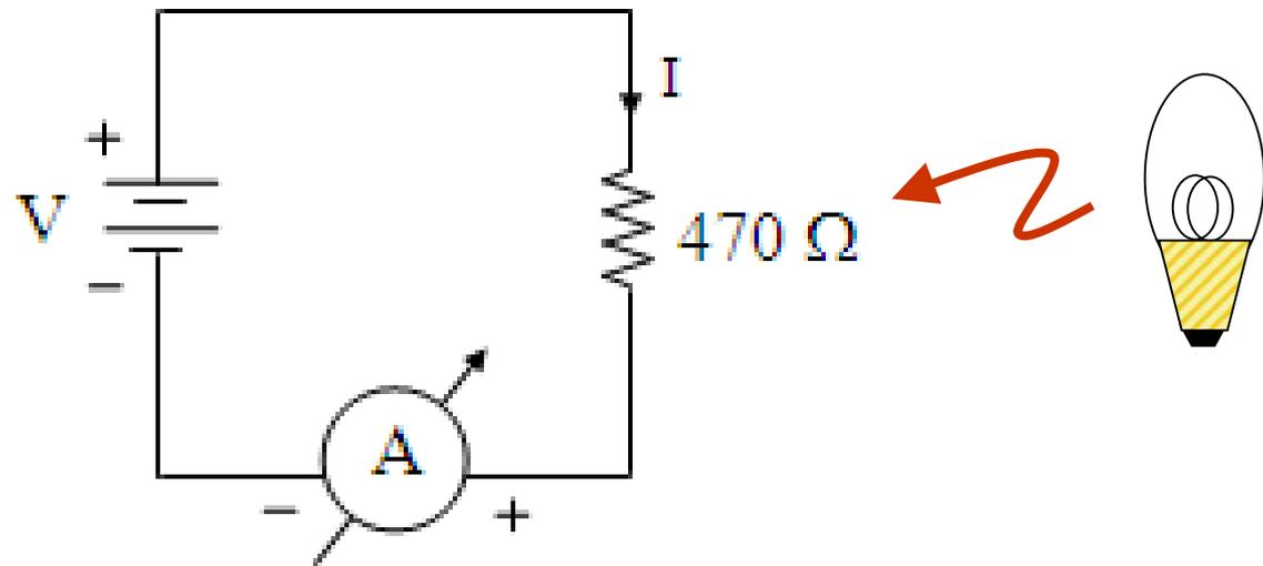
**Figura 10** – Circuito para Verificação da Lei de Ohm
