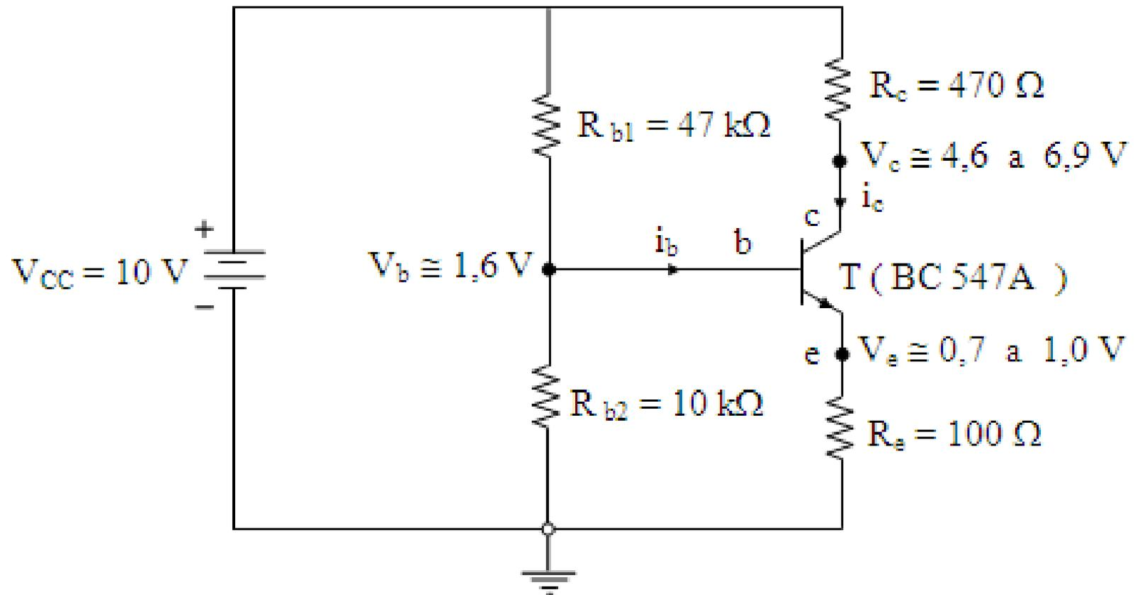
Figura 1 – Amplificador Transistorizado
