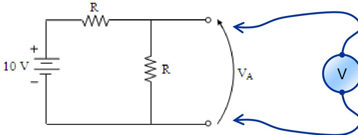
Figura 3 – Circuito para Verificação da Influência do Multímetro no Circuito sob Teste
