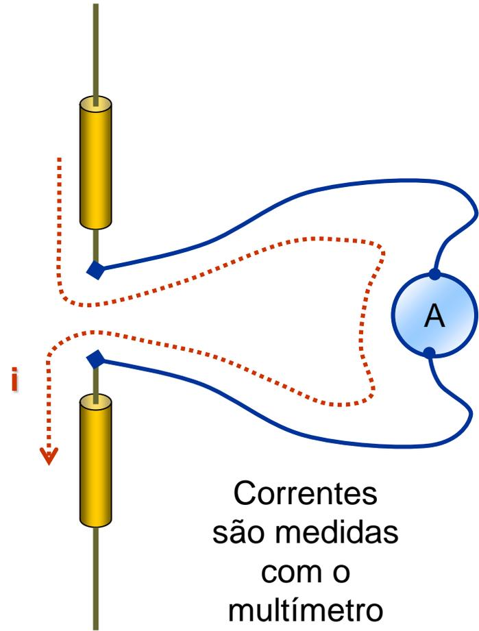
Correntes são medidas com o multímetro em série com o ramo
