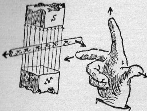
magnético, isto é, dispor paralelamente dois fios e passar a corrente através do primeiro. Em redor deste se estabelece então um campo magnético; e, se o segundo condutor se deslocar através dêle, teremos uma corrente induzida. Ou ainda há meio de modificar o campo, quanto ao tempo e não ao espaço, isto é, de o estabelecer lentamente, intensificando a pouco
