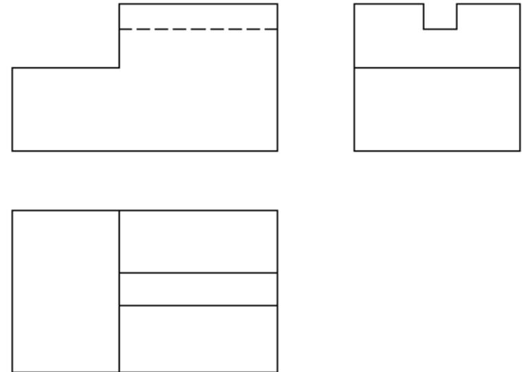
Figuras resultantes de projeções cilíndricas ortogonais de modo a representar com exatidão a forma do objeto com seus detalhes.
