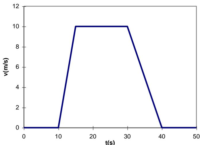
(b) O deslocamento entre as duas paradas corresponde à área sob a curva da velocidade. Desde que a figura forma um trapézio, calculamos essa área como
