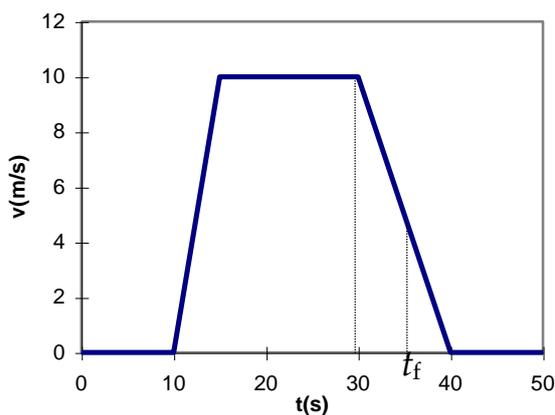
Na figura ao lado, marcamos com linha pontilhada a região do gráfico cuja área corresponde ao deslocamento entre  $t = 30$  s e um certo instante de tempo  $t_f$ . O instante de tempo que buscamos corresponde a  $t_f$  desde que o deslocamento seja de 25 m (obtido pela diferença entre o ponto determinado pela questão, 200 m, e o deslocamento até  $t = 30$  s, 175 m). A equação obtida impondo-se essa condição é
