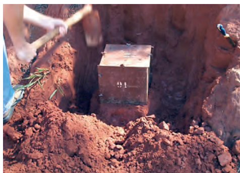
Figura 5 - Bloco sendo moldado em campo, com escavação nas laterais
