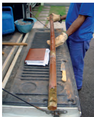
Figura 2 - Amostra de solo recuperada em amostrador interno tipo tubo liner .
