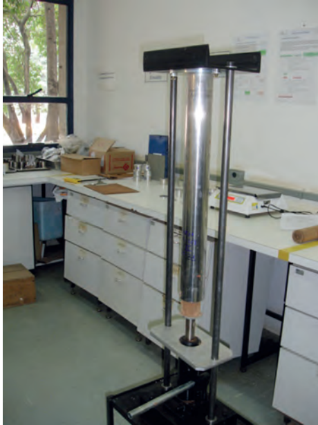
Figura 10 - Extrator de amostra sacando corpo de prova do amostrador Shelby
