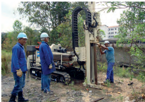
Figura 1- Equipe de campo em trabalho de coleta de amostras de solo/resíduo com penetrômetro multifunção usando amostrador para tubo liner .
