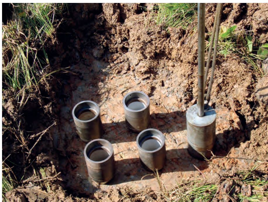
Figura 9 - Detalhe do amostrador tipo Uhland na profundidade de coleta de amostras indeformadas de solo em trincheira
