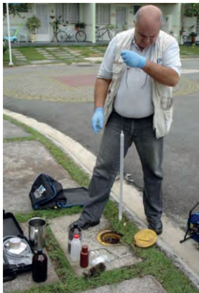
Figura 15 - Amostragem com bailer
