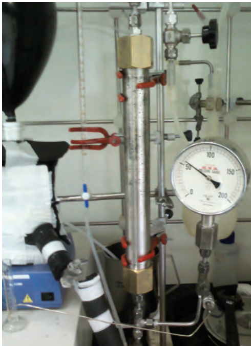
Figura 6 - Coluna de solo equipado com um medidor de pressão
