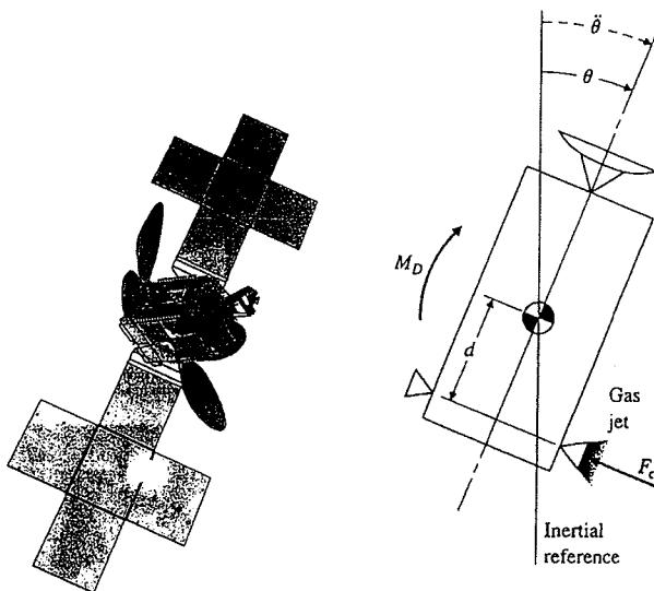
A figura ilustra o diagrama esquemático de um satélite que pode-se movimentar apenas no eixo perpendicular à esta folha de papel. O ângulo  $\theta$  é medido em relação a um referencial inercial. O sinal de controle provém de pequenos jatos que produzem um momento igual a  $F_c \times d$  em torno do centro de gravidade.
