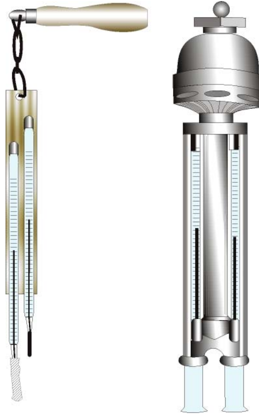
Fig. IV.2 - Psicômetro de funda (esquerda), cuja ventilação é obtida fazendo-se girar o suporte dos termômetros; e psicômetro Assmann (direita), com aspirador mecânico embutido na parte superior.
