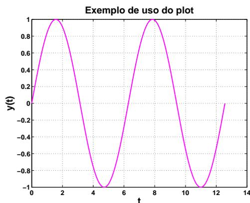
Note que ao usar o `plot` com o modo `-` ou sem especificar um formato de linha em especial, o Matlab liga os pontos obtidos tendo-se a impressão de uma curva contínua. Porém, na realidade, temos sempre um conjunto finito de pontos!
