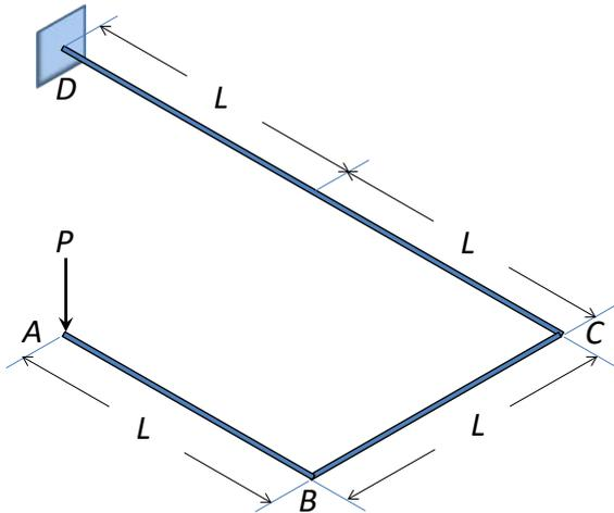
A estrutura horizontal da figura é formada por um arame de peso desprezível, dobrado em ângulos de  $90^\circ$ , e está engastada na sua extremidade  $D$ . Usando o *Princípio do Trabalho e da Energia*, pede-se calcular o deslocamento vertical sofrido pela extremidade  $A$  quando nela é aplicada uma força  $P$ , desprezando a energia devida às forças cortantes.
