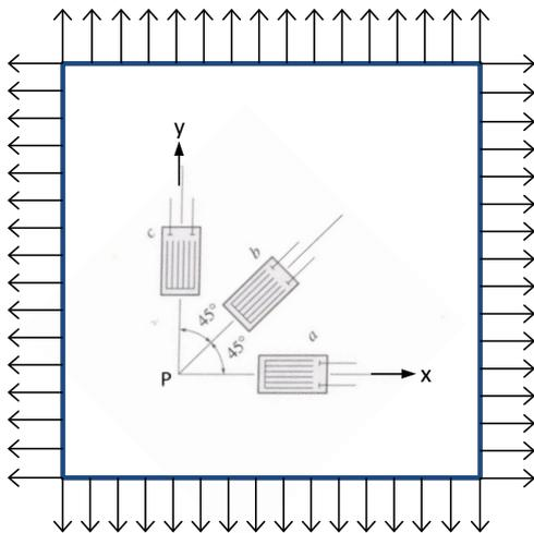
A placa quadrada da figura tem lado  $a = 200\text{mm}$  e espessura  $t = 10\text{mm}$ . Sobre ela foi colada uma roseta com extensômetros a  $45^\circ$ . Esta placa foi, então, submetida a um estado biaxial de tensão, com  $\sigma_x = 40\text{MPa}$  e  $\sigma_y = 20\text{MPa}$ , conforme a figura. Com a aplicação desse carregamento, as leituras obtidas dos extensômetros  $a$  e  $c$  foram, respectivamente,  $\varepsilon_a = 300\mu$  e  $\varepsilon_c = 0$ . Pede-se:
