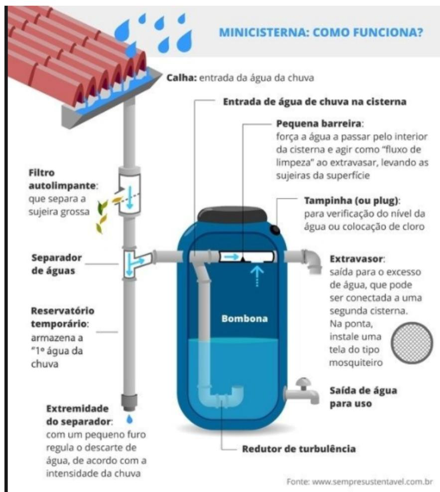
Figura 2-15: Esquema de funcionamento de minicisternas.
