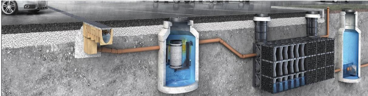
Figura 10 - Sistema de tanque de armazenamento de água pluvial
