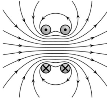
**Figura 2** – Figura esquemática mostrando a bobina de Helmholtz.
