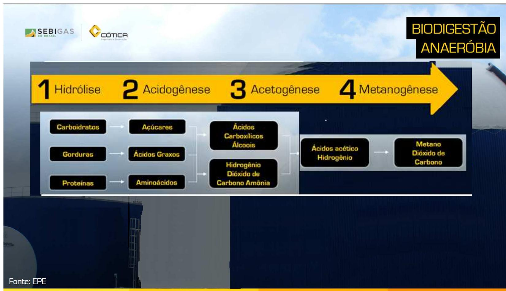
Figura 8: Fases metabólicas envolvidas na digestão anaeróbia
