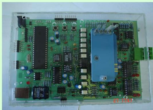
Foto do circuito eletrônico do fotômetro desenvolvido. O circuito eletrônico está protegido por uma caixa de acrílico.
