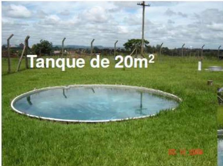
O tanque de 20m<sup>2</sup> é utilizado para medir a evaporação (E<sub>20</sub>). Suas medidas se assemelham às obtidas em lagos. Portanto, sofre pouca influência de fatores externos, dado o grande volume de água que ele contém.
