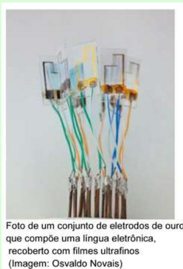
Foto de um conjunto de eletrodos de ouro, que compõe uma língua eletrônica, recoberto com filmes ultrafinos (Imagem: Osvaldo Novais)
