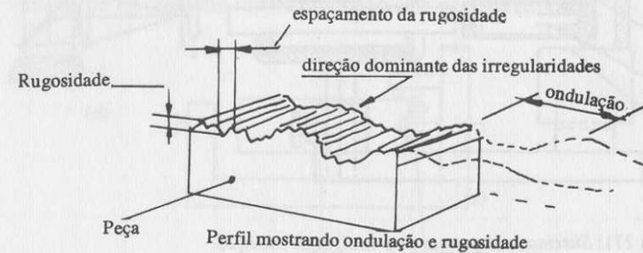
Figura 270: Perfil mostrando ondulação e rugosidade
