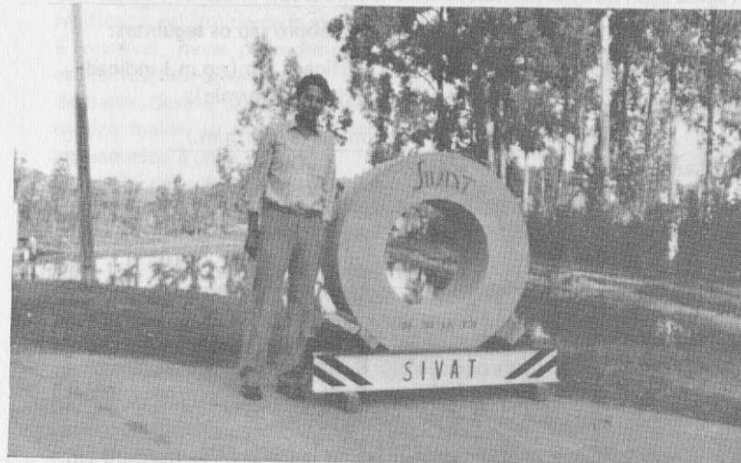
Rebolo vitrificado para fabricação de limas. - 1260 x 480 x 630mm. - Peso 1000 Kg
