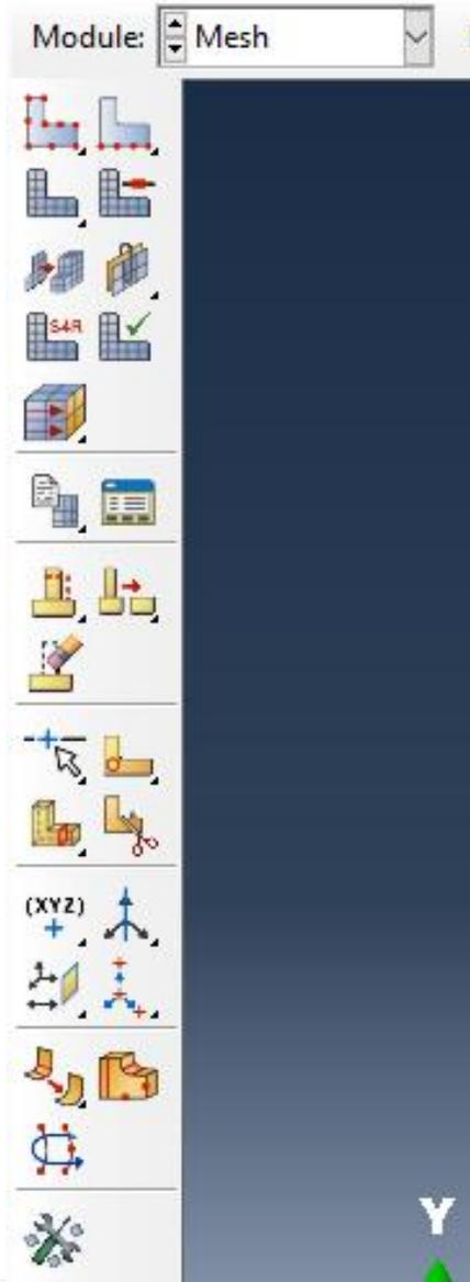
Na lista Module, localizada na barra de ferramentas, clique em Mesh para entrar no módulo de malhamento do problema.
