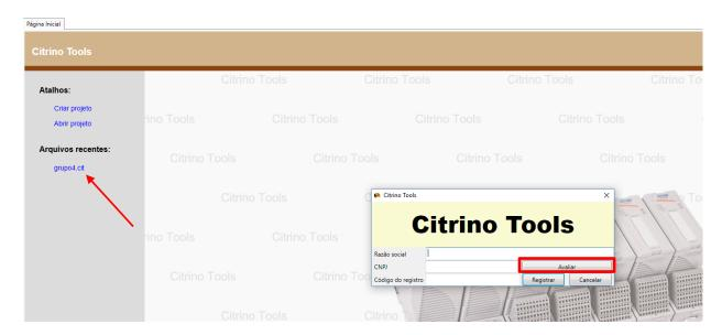
2 – Faça os procedimentos descritos no Tutorial de configuração do Citrino Tools. Vá em "Ethernet" e "Pesquisar rede". Depois, clique em "Buscar rede" e conecte-se ao PLC. Depois, vá em "Comunicação" e "Armazenar configuração e dados da memória".
