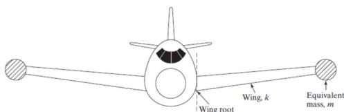
Determine a resposta da massa  $m$  localizada na extremidade livre da asa sabendo-se que a rigidez equivalente da asa é igual a  $k$ , obedecendo o modelo de 01 GDL.
