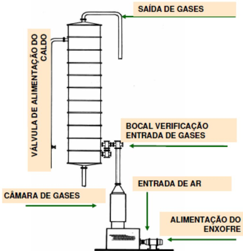
Figura - Sistema de sulfitação.
