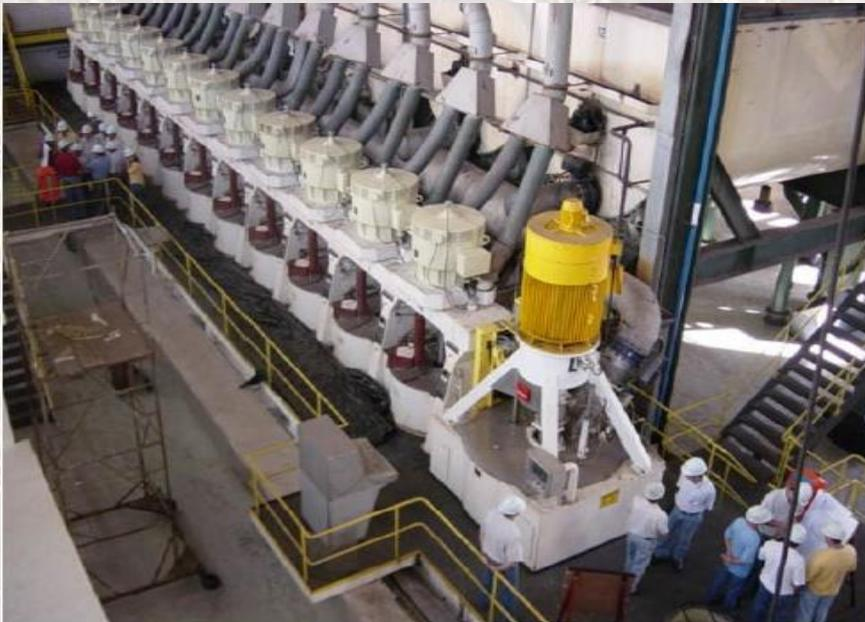
Figura – centrífugas descontinuas ou intermitentes.
