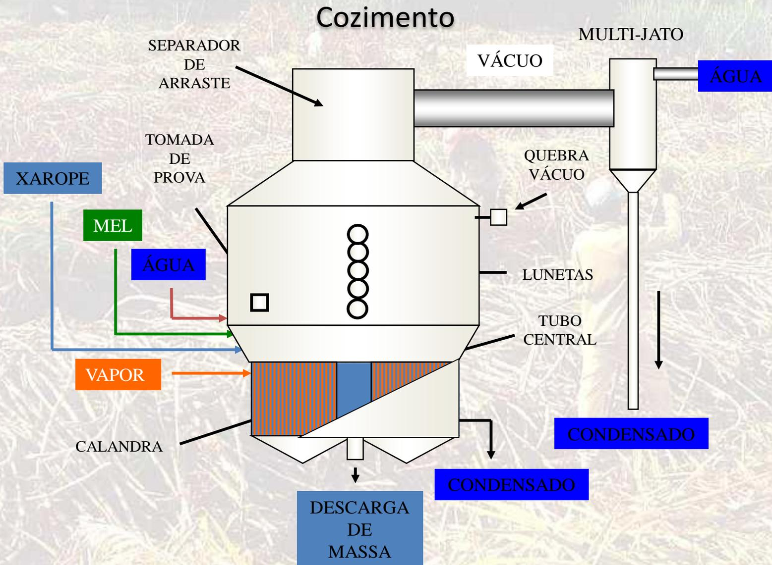
Figura – Descrição de um cozedor intermitente clássico.
