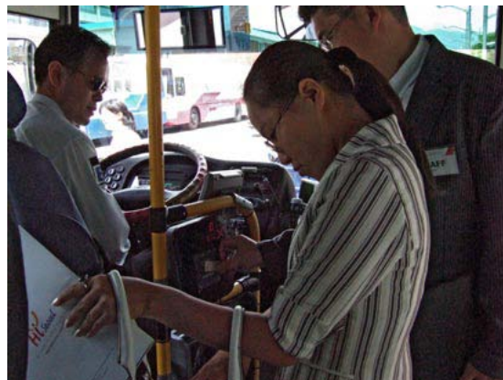
Figuras 8.17 e 8.18 O sistema de corredores de ônibus de Seul usa tecnologia de cartões magnéticos para cobrança (foto esquerda). Entretanto, a verificação de pagamento a bordo implica que os tempos de parada na estação são negativamente afetados. Um único passageiro procurando por seu cartão entre seus pertences pode criar uma demora relevante (foto direita).
