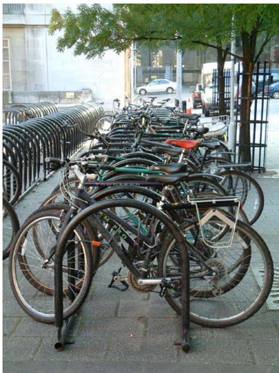
Figura 13.95 Um poste em formato de U é uma alternativa de baixo custo e relativamente segura.
