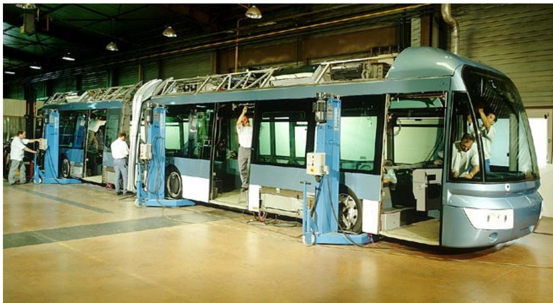
Figura 12.47 A fabricação especializada de baixos volumes de veículos pode aumentar drasticamente os custos totais.
