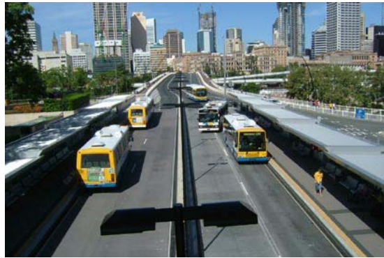
Figuras 3.20 e 3.21 Brisbane calculou mal a demanda em uma estação principal resultando em relevante congestionamento na via de ônibus (foto esquerda). O problema teve de ser finalmente corrigido com uma reforma algo custosa de uma faixa de ultrapassagem na estação (foto direita).
