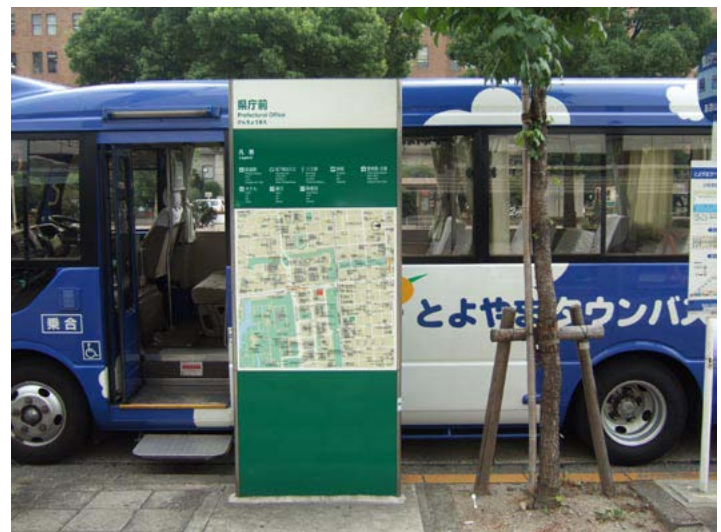
Figura 13.78 Em Nagoya, um veículo alimentador equipado com uma ponte de embarque retrátil torna o embarque mais fácil para muitos usuários.
