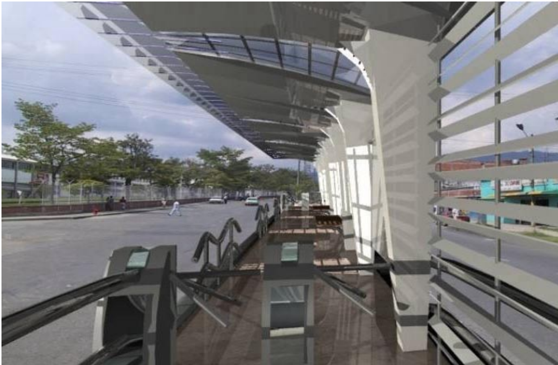
Figura 11.54 Um desenho de estação pode oferecer abertura para um bom fluxo de ar tão e proteção contra evasão de pagamentos.
