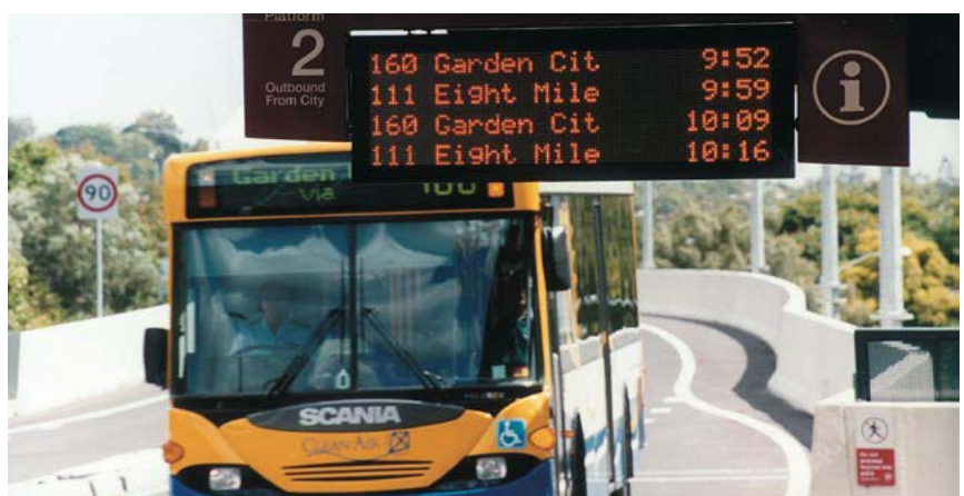
Figura 10.17 Painéis de mensagem variável ao longo de uma plataforma no sistema de vias de ônibus de Brisbane.
