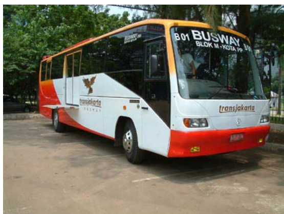
Figuras 8.31 e 8.32 O uso de uma única porta em Jacarta limitou bastante a capacidade viável para o sistema.
