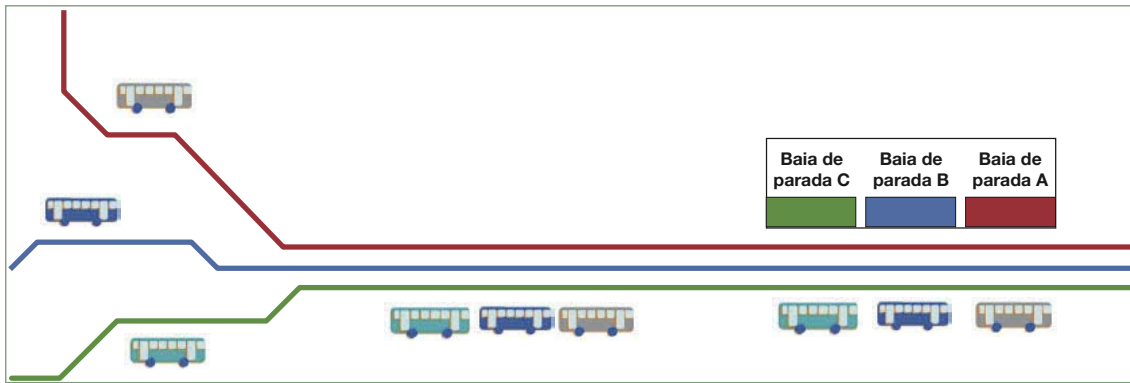
Figura 8.39 Sistemas de comboio funcionam ao permitir que múltiplas linhas andem juntas como um “trem” de veículos ao longo do corredor troncal.
