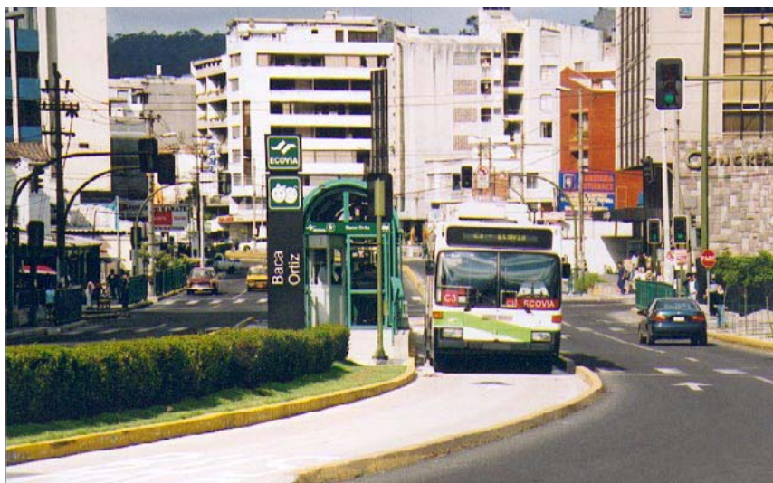
Figura 5.59 ▼ Quito empregou brevemente movimentos no contrafluxo em sua linha Ecovía, uma vez que os veículos iniciais tinham as portas “do lado errado”.
