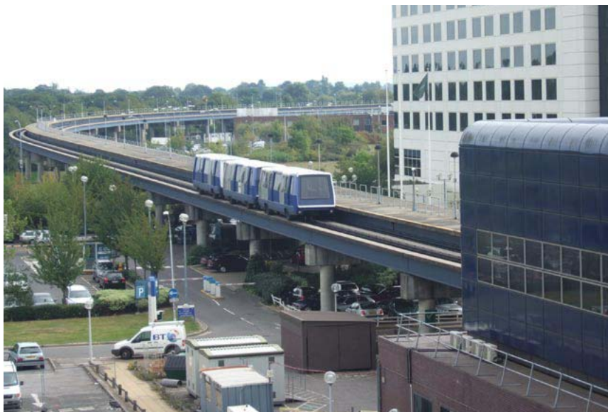
Figura 15 Um veículo sobre pneus em uma via elevada oferece serviços de transporte público entre os terminais do Aeroporto de Londres Gatwick.
