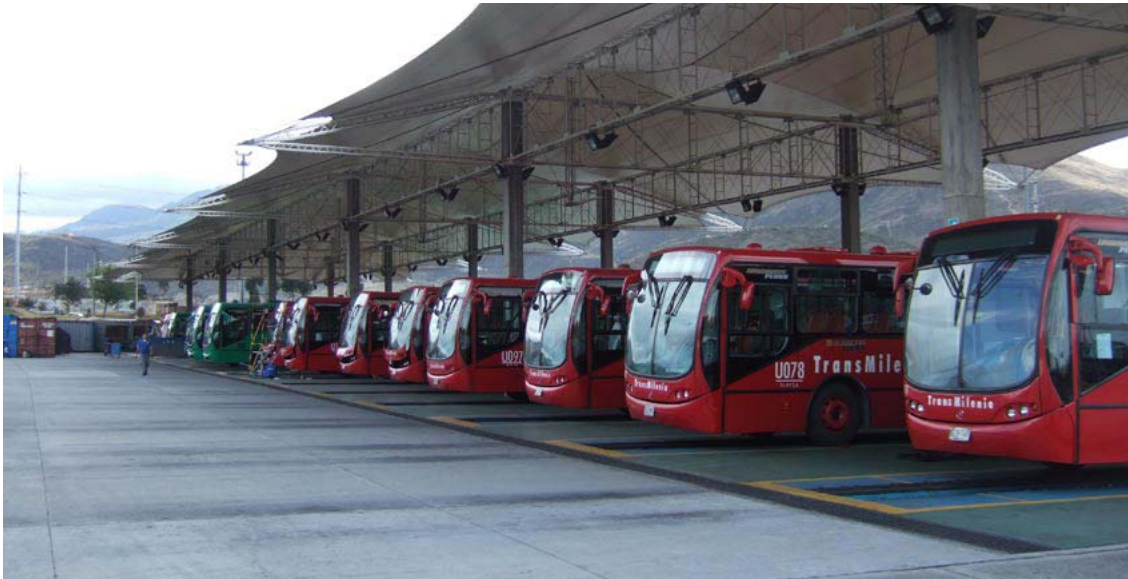
Figura 8.14 O tamanho da frota de veículos requerida depende da demanda do corredor, tempo de viagem para completar um ciclo no corredor e da capacidade de passageiros de cada veículo.
