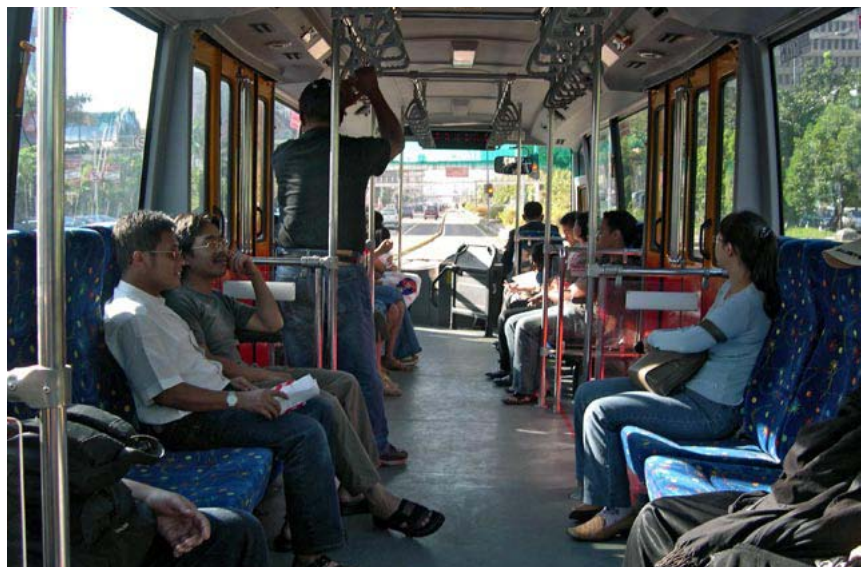
Figura 12.17 Assentos de lado, como mostrados neste exemplo de Jacarta, tendem a maximizar o espaço para passageiros de pé e, assim, essa configuração maximiza a capacidade global de passageiros por veículo.
