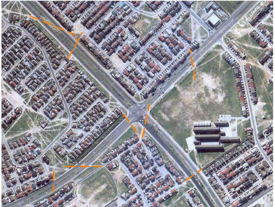
Figura 13.20 Imagem aérea mostrando onde as pessoas cruzam a rua em uma vizinhança da Cidade do Cabo (África do Sul). Foto por cortesia do ITDP
