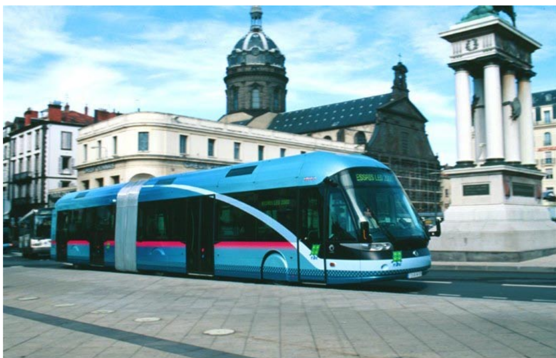
Figura 2.55 Veículos modernos podem dar aos sistemas BRT uma imagem altamente profissional. O veículo nesta foto é um ônibus Civis, e não um VLP.
