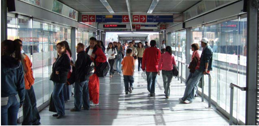
Figura 11.87 Bogotá utiliza estações com múltiplas baias de parada de forma a permitir transferências em plataforma para usuários desejando mudar de uma linha para outra.
