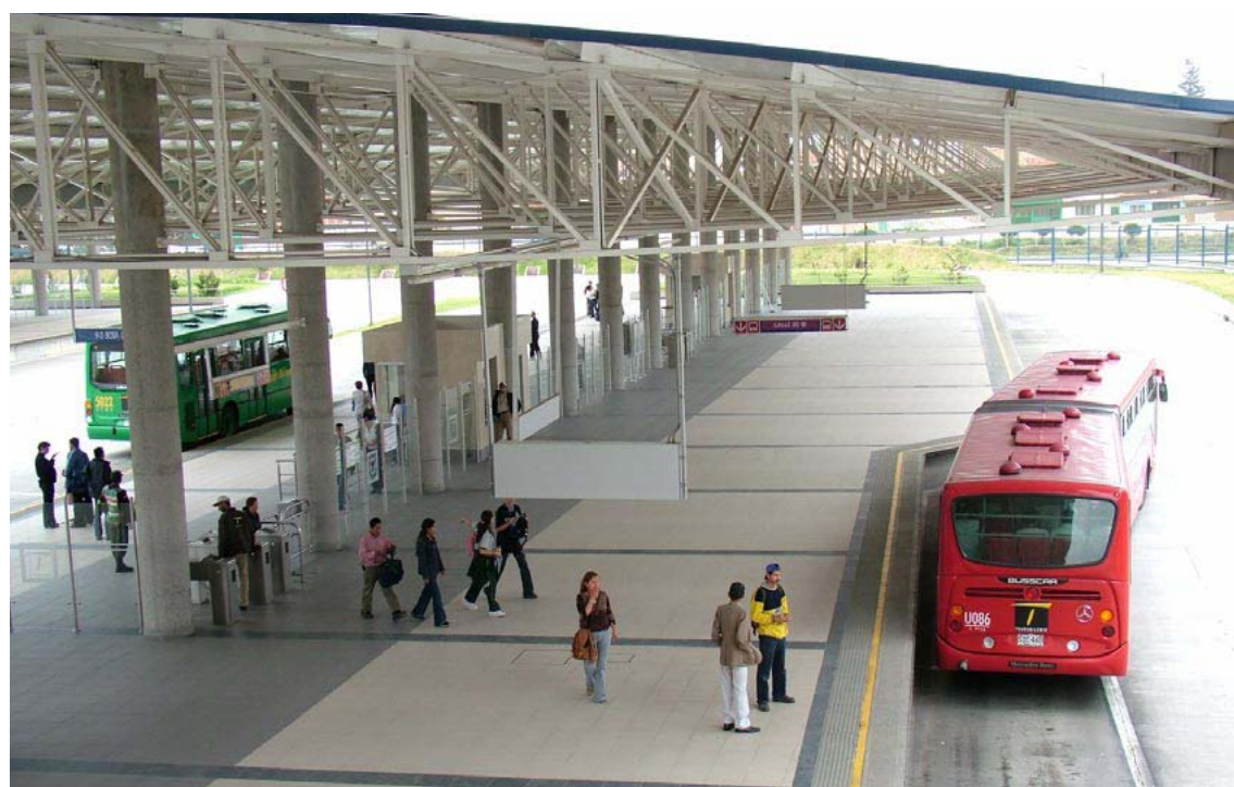
Figura 7.11 Em sistemas tronco-alimentadores, como o TransMilenio de Bogotá, os usuários se transferem dos veículos alimentadores (ônibus verde à esquerda) para os veículos “troncais” (veículo vermelho à direita) em “terminais”.
