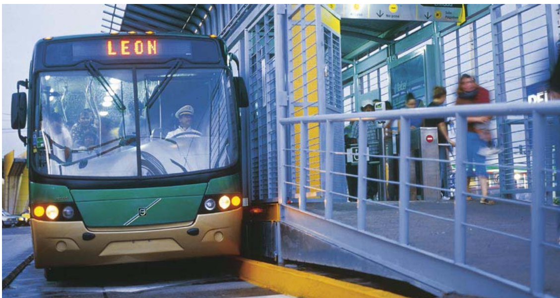
Figura 12.13 Veículos de piso alto em conjunto com embarques de plataformas em nível são uma solução de custo eficiente na maioria dos sistemas de alta qualidade da América Latina, como o sistema em Leon.
