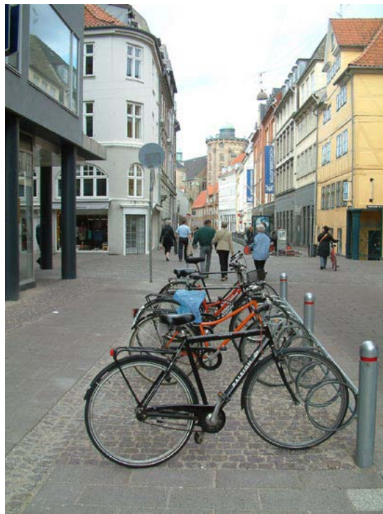
Figura 13.96 O oferecimento de estacionamentos de bicicleta apenas com a roda da frente amarrada pode ser menos seguro.
