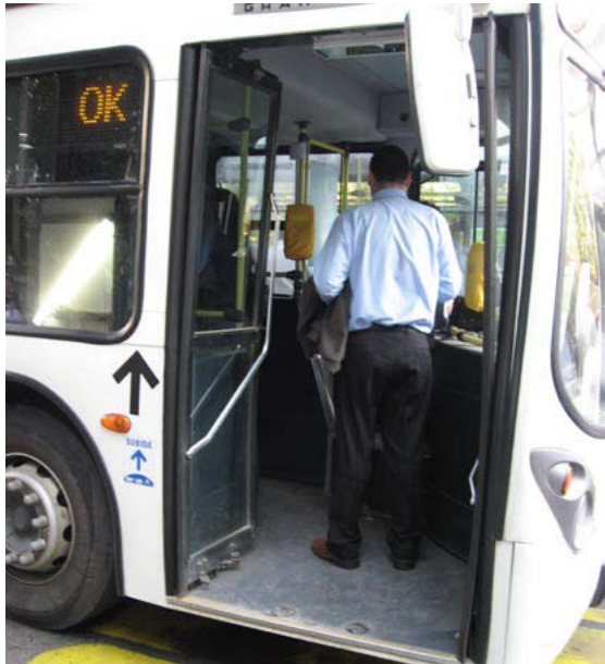
Figuras 12.10 e 12.11 Veículos de piso baixo sem embarque em nível e cobrança externa podem resultar em longos tempos de parada e não oferecer realmente acesso para deficientes físicos, como mostrado nestas imagens de Santiago (foto esquerda) e Brisbane (foto direita).
