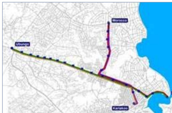
Figuras 5.17 e 5.18 Dar es Salaam considerou duas opções para o itinerário de seu BRT, no centro da cidade: 1.) Uma configuração de alameda de transportes com os dois sentidos de BRT na mesma rua; 2.) Um itinerário dividido com cada sentido utilizando uma rua diferente. No fim, Dar es Salaam escolheu a configuração de alameda de transporte público que se parece mais com uma estrutura de metrô.
