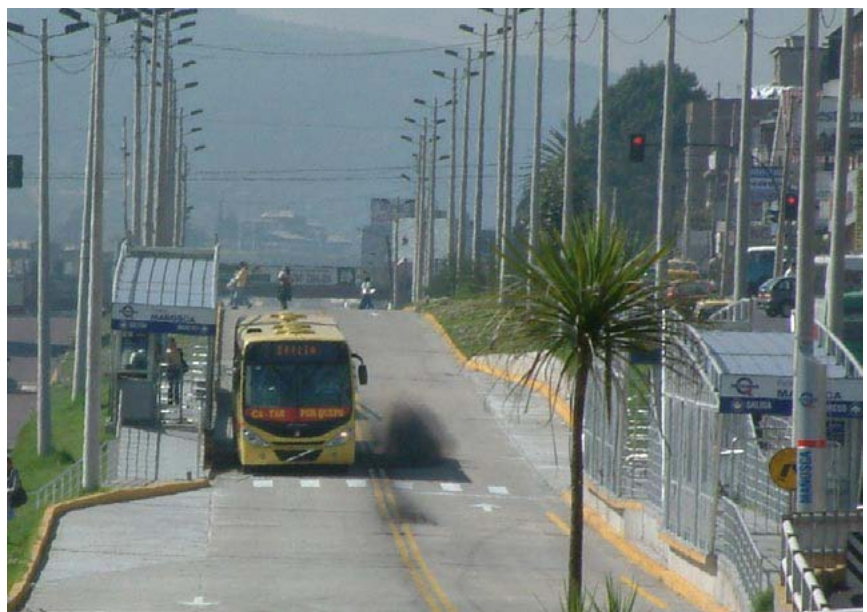
Figura 12.25 No corredor Central Norte de Quito, os veículos compatíveis com Euro 3 não estão produzindo os resultados desejados por causa do uso de combustível diesel de 500 ppm.
