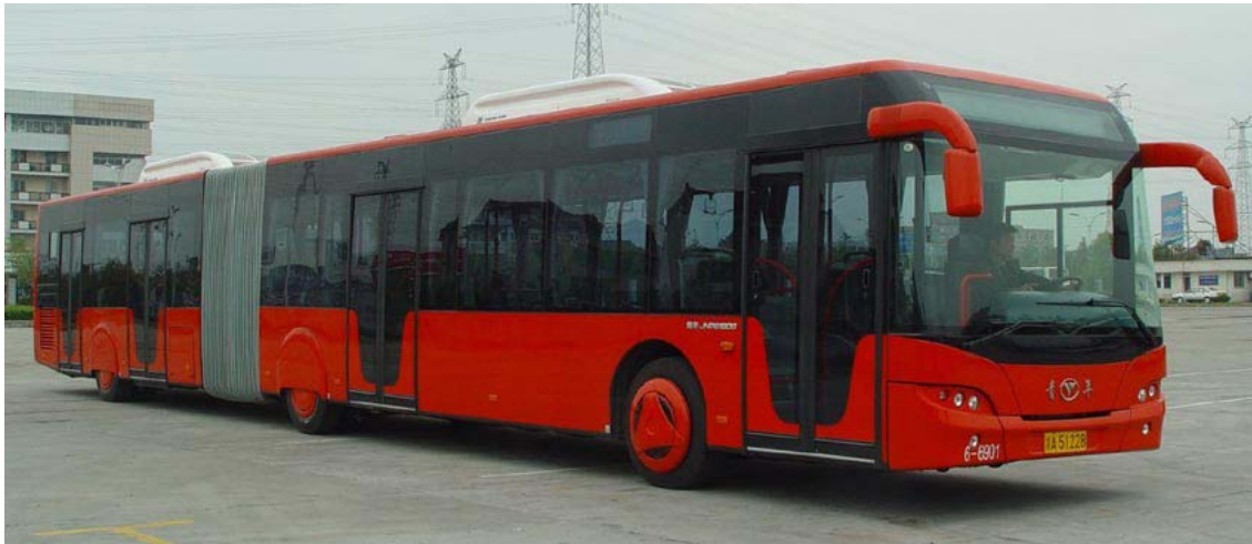
Figura 8.12 O veículo articulado de 18.5 metros se tornou o padrão em muitas aplicações de BRT.
