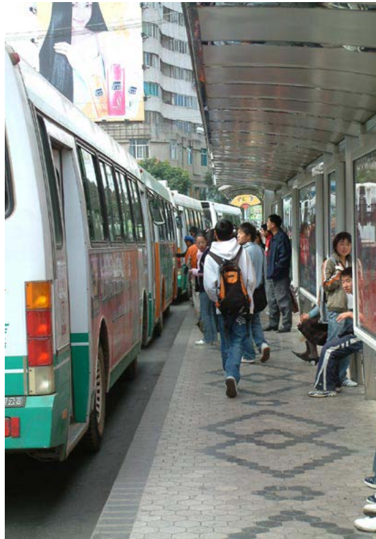
Figura 7.5 A cidade de Kunming utiliza um sistema “aberto” de corredores, utilizando faixas de ônibus segregadas, mas com poucas reformas estruturais ou de itinerários.
