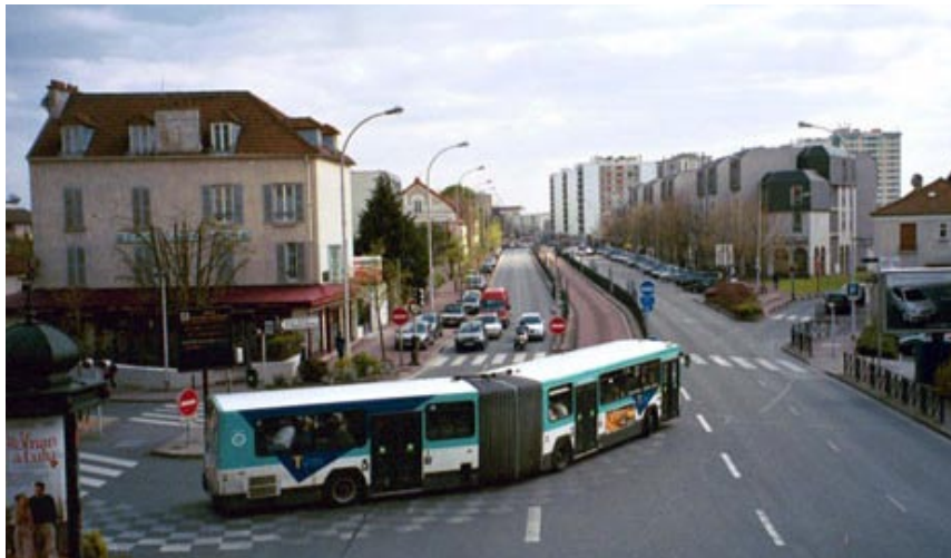
Figura 9.9 ▼ A fase verde para um veículo de BRT entrando na via de ônibus Val de Marne em Paris.
