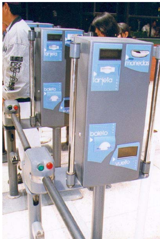
Figura 12.54 Esta máquina de verificação em Quito lida tanto com moedas quanto com um bilhete de tarja magnética.
