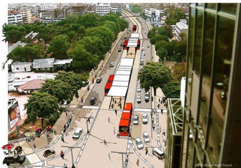
Figura 1.9 Um modelo visual do sistema de BRT proposto para Dar es Salaam, usando uma combinação de fotografia digital com software de design gráfico.
