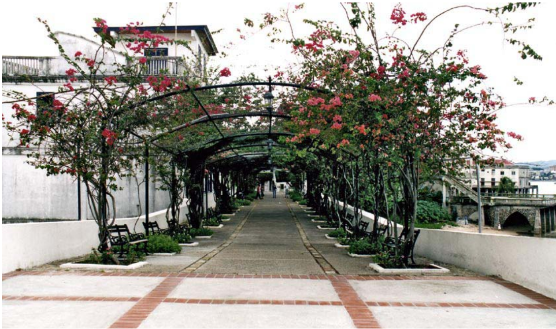
Figura 13.69 Como este exemplo da Cidade do Panamá ilustra, calçadas cobertas ajudam drasticamente a reduzir as temperaturas do pavimento e assim tornar a caminhada mais confortável.
