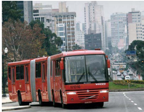
Figura 12.3 Em Curitiba, veículos biarticulados de 24 metros são utilizados nos corredores troncais.
