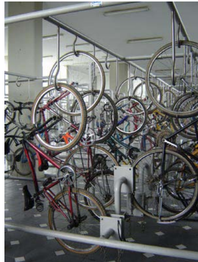
Figura 13.93 O estacionamento de bicicletas na vertical usado em TransMilenio economiza espaço, mas pode ser difícil para a utilização de muitos.
