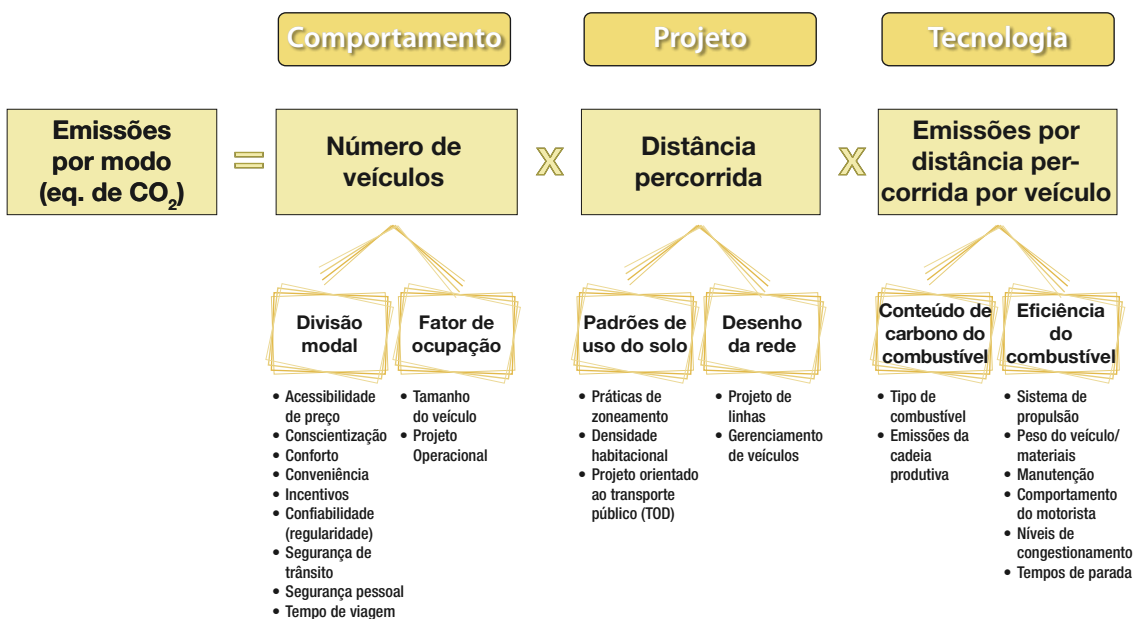
Figura 19.21 Uma equação generalizada de emissões também registra todos os componentes constituintes de fontes de emissão.
