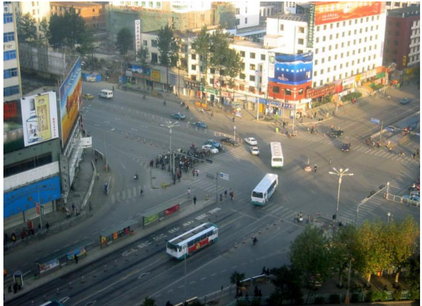
Figura 9.35 Em Kunming, veículos de BRT que estão à espera para virar devem deixar a via de ônibus e entrar na faixa de tráfego misto para completar o movimento de conversão.
