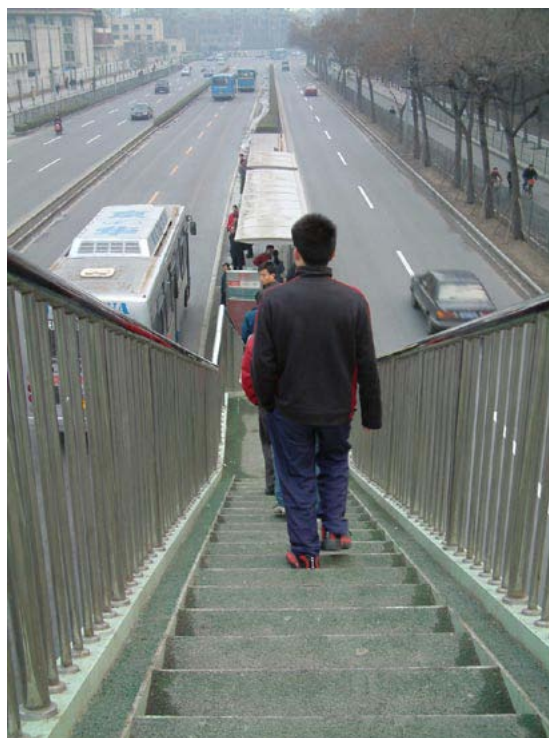
Figura 13.45 Uma escada íngreme e estreita em Beijing compõe um acesso ruim para o sistema de BRT.
