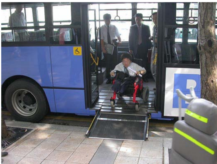
Figura 13.77 Uma rampa manualmente operada a partir do ônibus pode oferecer avesso para usuários em cadeiras de roda.
