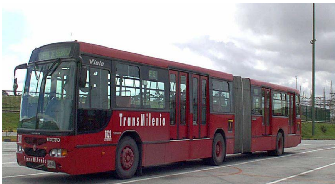
Figura 12.18 Bogotá utiliza uma configuração de quatro portas que ajuda a reduzir os tempos de embarque e desembarque.
