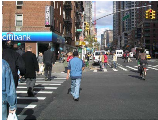
Figuras 13.41 e 13.42 Fases de pedestre e de veículos de uma programação semafórica com tempo inicial de pedestres (LPI) na Cidade de Nova Iorque.
