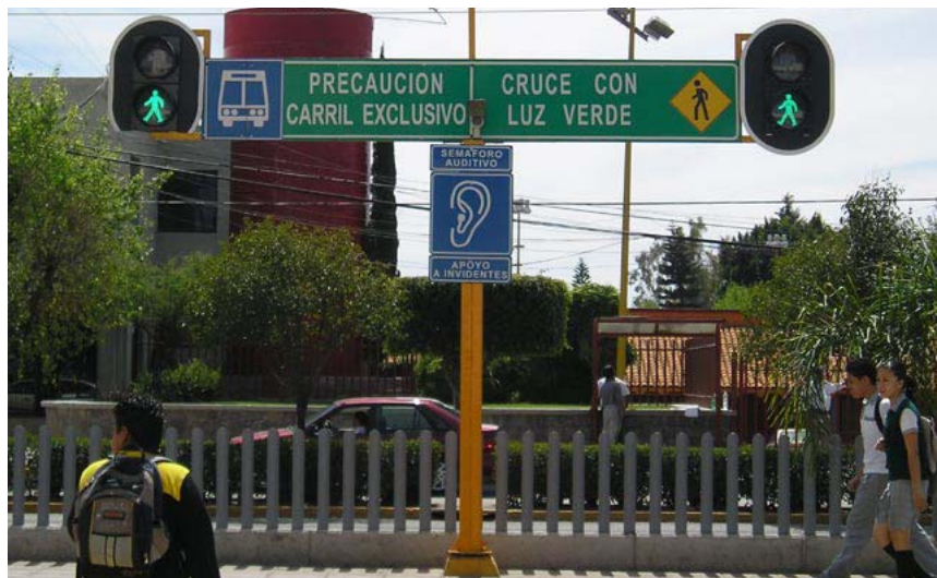
Figura 13.84 Semáforos auditivos em um cruzamento levando a uma estação de BRT em Leon (México).
