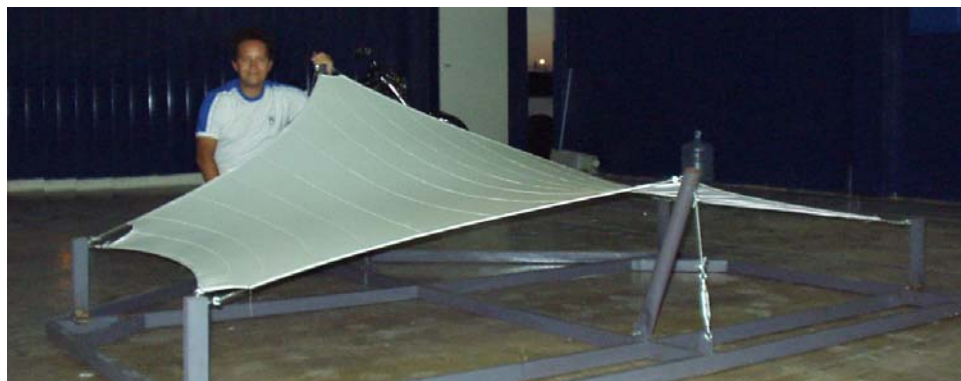
Figura 10. 1:10 scale fabric model of the membrane of the 'Memorial dos Povos de Belém do Pará'.
