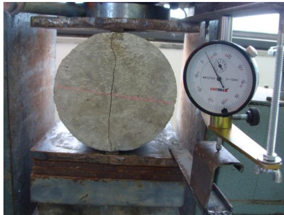
Figura 10 – Ensaio de compressão diagonal com armadura de fendilhamento.
