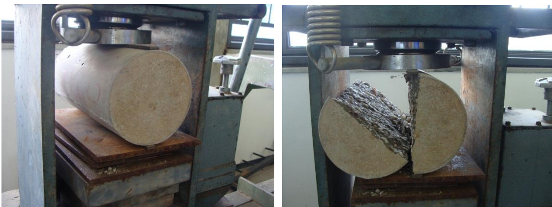
Figura 9 – Ensaio de resistência à tração do concreto por compressão diametral.
