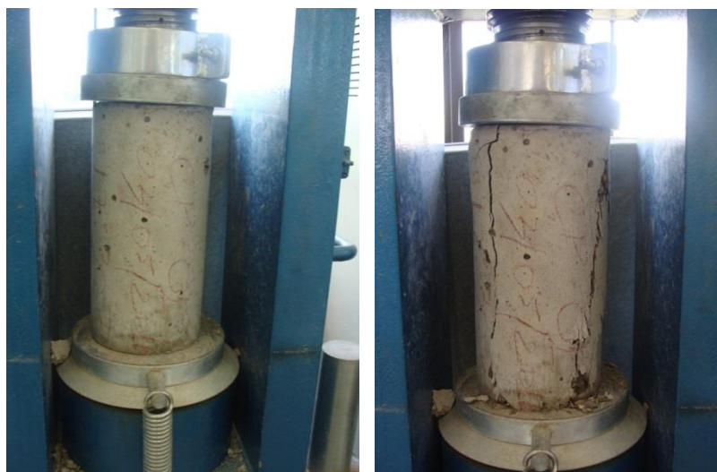
Figura 7 – Ensaio de resistência à compressão de concreto com ruptura tipo coluna – observar fissuras verticais paralelas.
