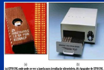
(a) EPROM, onde pode-se ver a janela para irradiação ultravioleta. (b) Apagador de EPROM.
