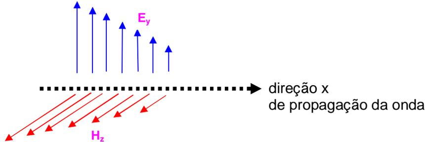
Figura 22. 2 – polarização e direção de propagação de onda onda plana
