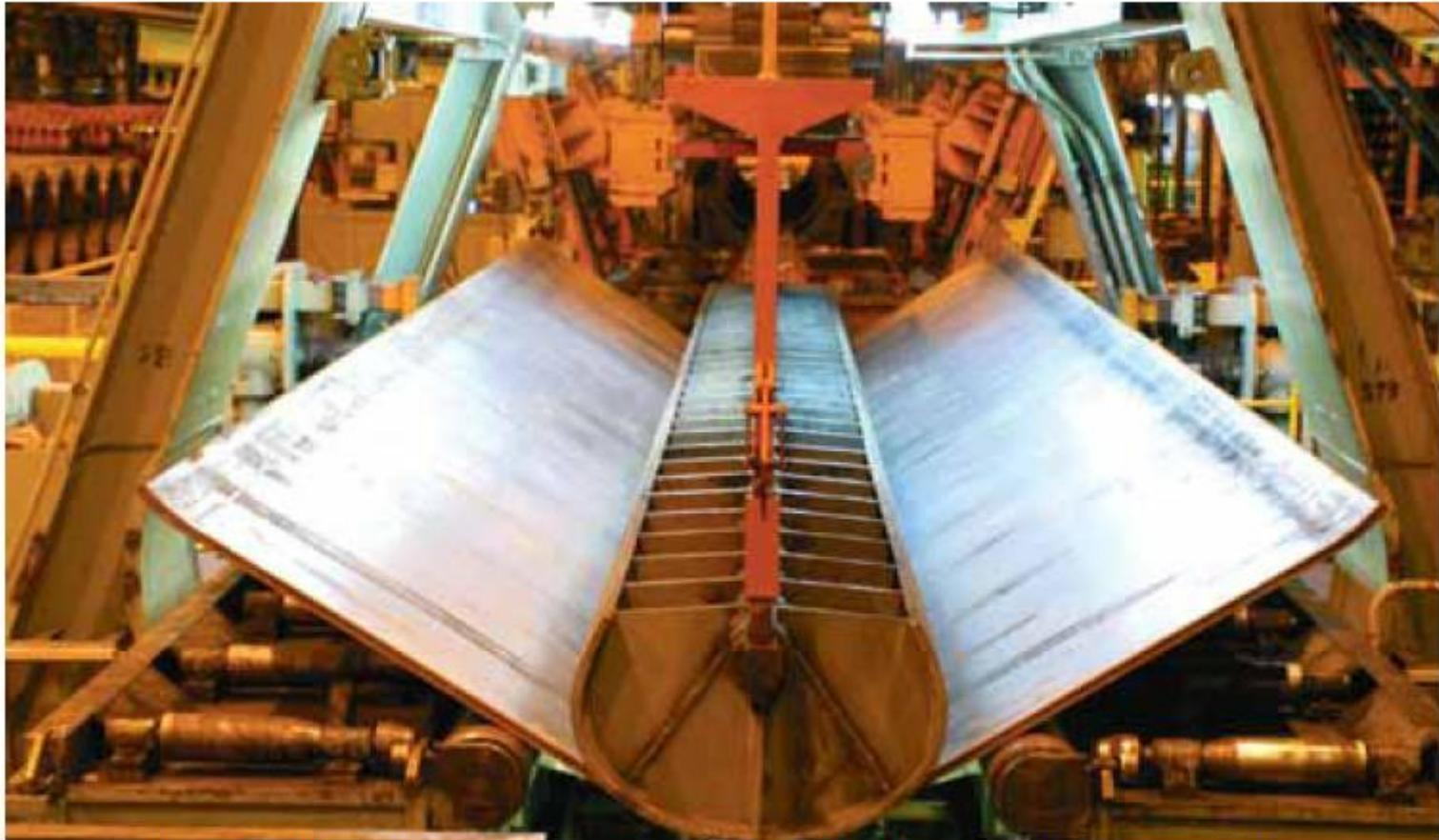
**Figura 5 – Etapa de conformação do método SAW – Formação U-O-E (prensa U)**
