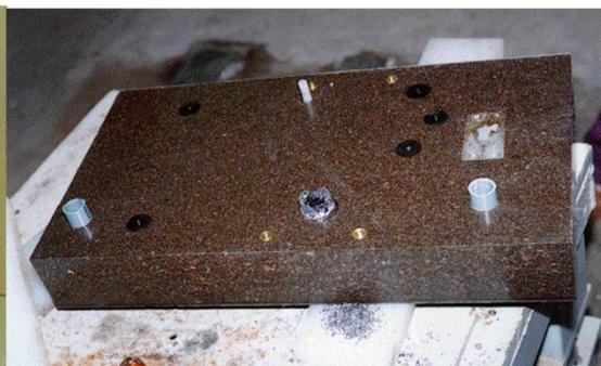
**BASE DA RETIFICADORA DE CORPOS-DE-PROVAS DE CERÂMICA- Molde e Base.**
