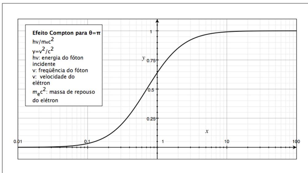
Nas condições da experiência de Compton (R-X com  $\nu = 4.22 \times 10^{18}$  Hz, correspondendo a  $E_{R-X} = 17.44$  keV, incidindo sobre carbono), tratar o elétron relativisticamente não deveria ser essencial, pois  $v^2/c^2$  é da ordem de 0.004 quando  $E_{R-X}/m_e c^2 = \frac{17.44 \text{ keV}}{511 \text{ keV}} \sim 0.034$ , tornando aceitável o uso de mecânica não-relativística para o elétron.
