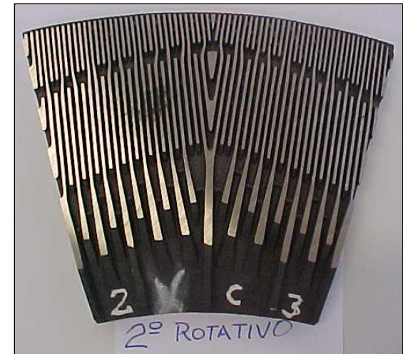
Figura 3. Ilustração de um refinador de discos (a) e fotografia de uma fração de um disco refinador (b) com as ranhuras responsáveis pela ação abrasiva sobre os cavacos de madeira.
