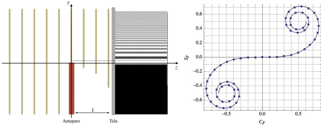
Figura 2: Esquerda: uma onda plana incide sobre um anteparo limitado ao semi-plano infinito  $y < 0$ , sendo depois projetada na tela. Direita: cosseno  $C_F(u)$  e seno  $S_F(u)$  de Fresnel. Os pontos marcam intervalos de  $\Delta u = 0.1$ , com  $u = 0$  sendo a origem. A posição  $\{C_F = -1/2, S_F = -1/2\}$  corresponde a  $u \rightarrow -\infty$ , e a posição  $\{C_F = 1/2, S_F = 1/2\}$  corresponde a  $u \rightarrow \infty$ .
