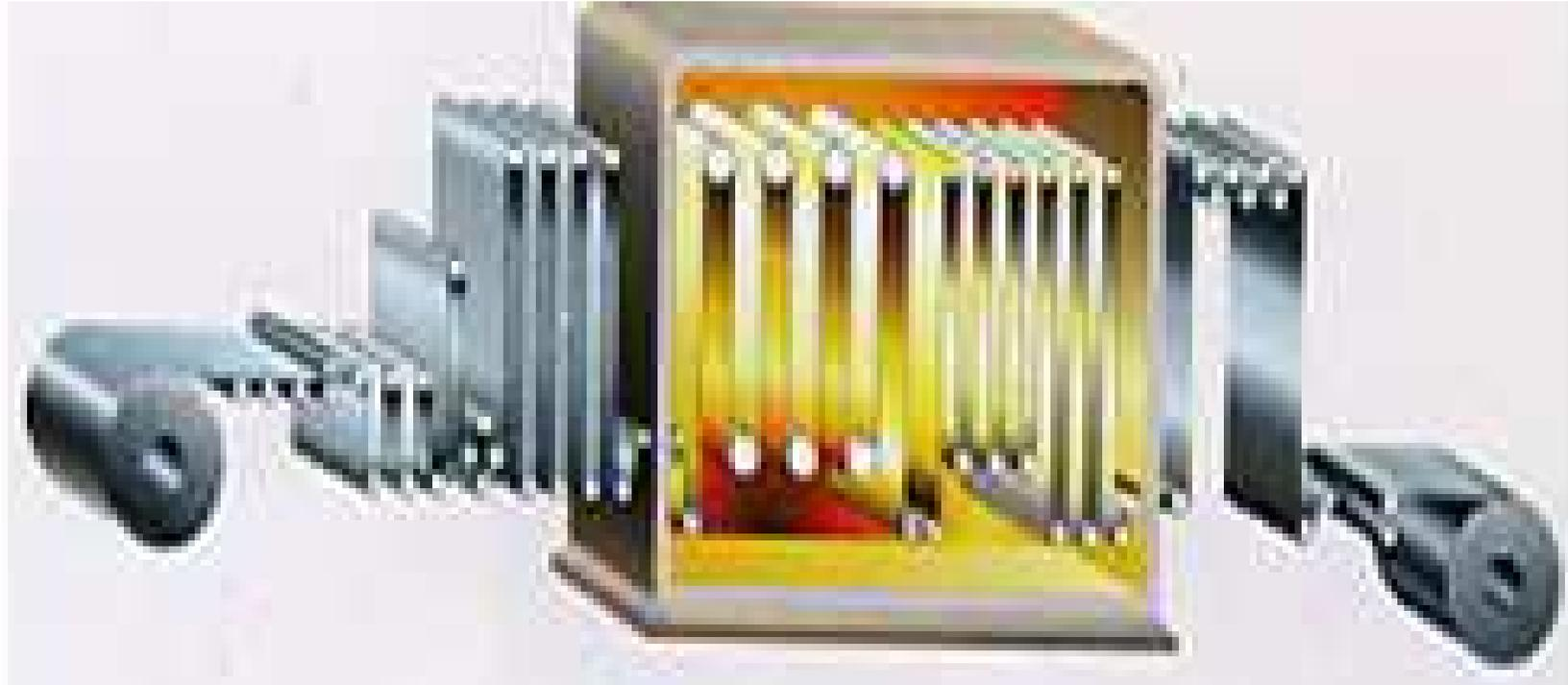
Chapa passa em alta velocidade por forno a 900° C
