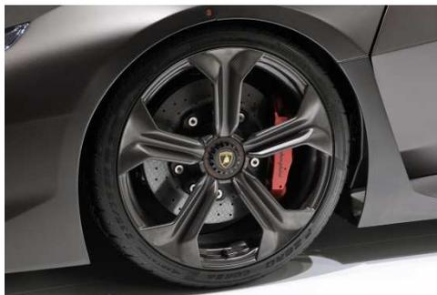
Novo processo de produção: onde um composto pastoso de fibra de carbono e resina epóxi é injetado a alta pressão em moldes especiais. Este novo material foi chamado de *Forged Composite* (compósito forjado, em alusão aos processos de forjamento de alta pressão em moldes fechados).
